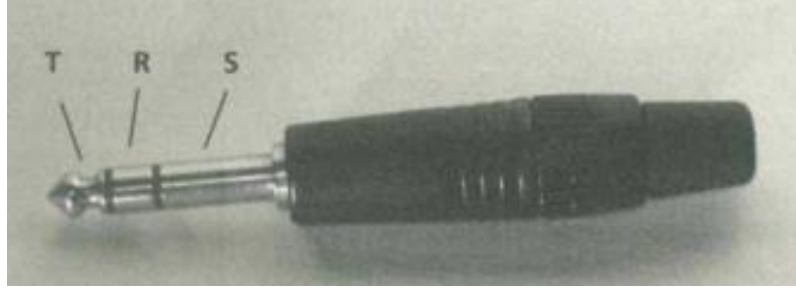
Şekil 8. 1/4" Stereo-1/4" Balanced-1/4" TRS Erkek Konnektör
