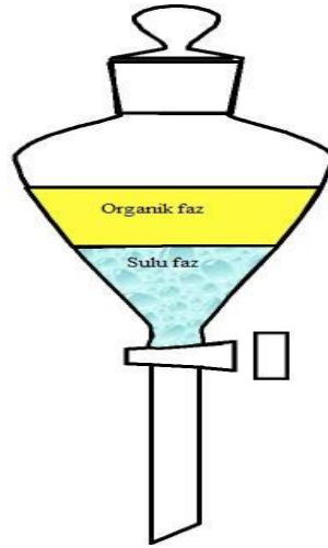
Şekil 2.2. Solvent ekstraksiyonda faz ayırma balonunun şematik gösterimi.
