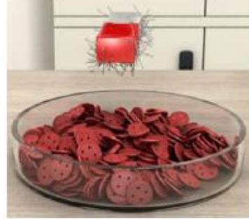
Mıknatıs ile toplu iğne-düğme karışımının ayrılması
