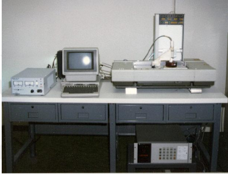
Şekil 2.1 : Charles HULL tarafından üretilen ilk 3B yazıcı [50].
