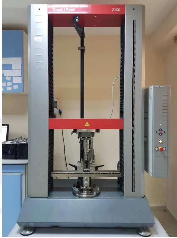
Şekil 3.42 : Zwick/Roell Z100 malzeme test cihazı – Eğilme testi.
