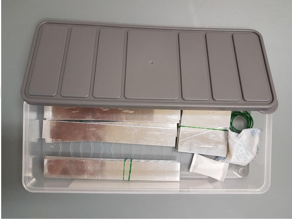
Şekil 3.16 : Metal levhaların saklama kabında muhafaza edilmesi.
