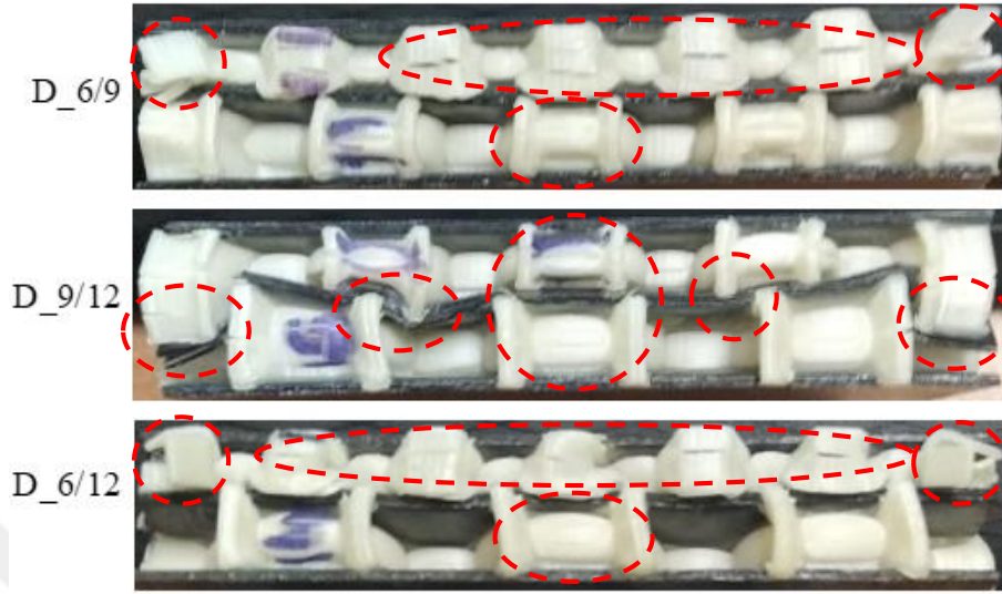
Şekil 5.44: Hibrit iki katlı sandviç kompozitlerin basma testi sonrası deformasyon görüntüleri.
