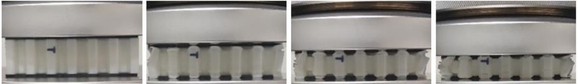
Şekil 5.33: Tek katlı S_6 sandviç kompozit numunelerin basma testi deformasyon görüntüleri.
