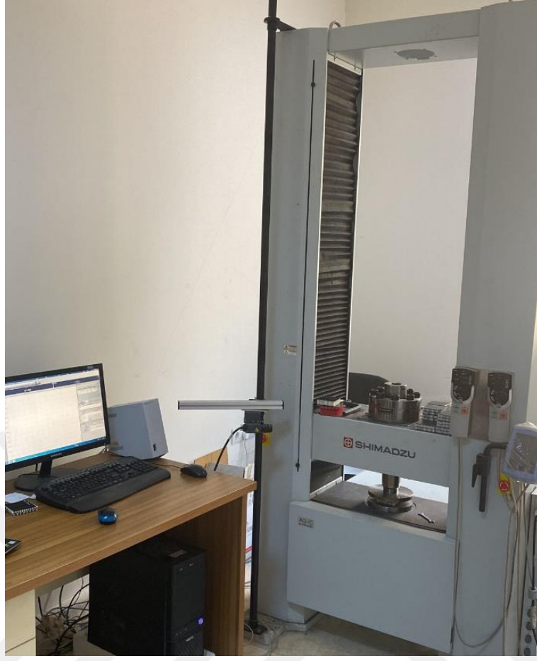
Şekil 4.26: Shimadzu AG-IC 250 kN kapasiteli üniversal çekme test cihazı görüntüsü.
