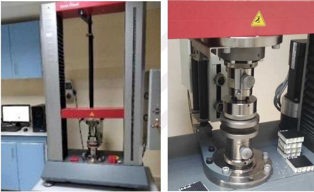
Şekil 4.24: a) Zwick/Roell Z100 basma test cihazı görüntüsü b) Numuneyi alt tablaya merkezini sağlayan şablonun görüntüsü.
