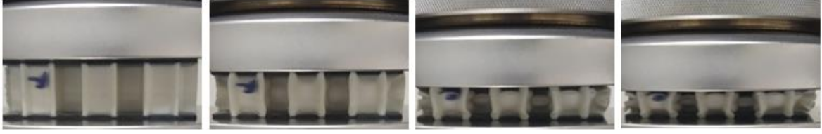
Şekil 5.35: Tek katlı S_12 sandviç kompozit numunelerin basma testi deformasyon görüntüleri.
