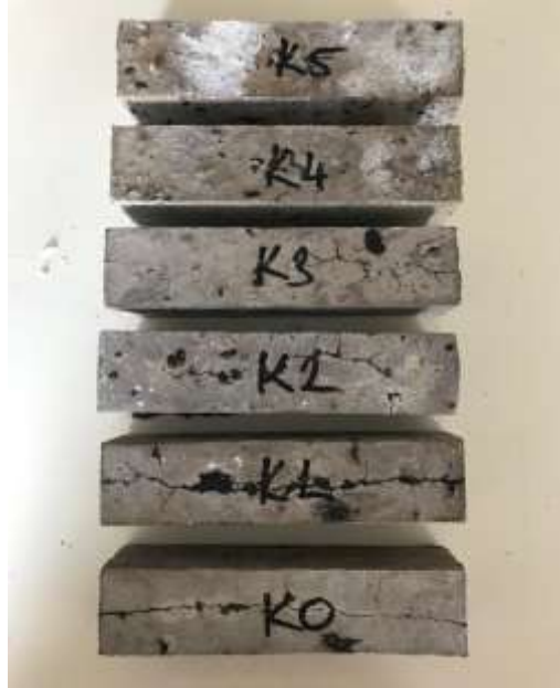
Şekil 4.20: %3 MgSO 4 çözeltisinde 12 hafta bekletilen prizma numunelerin görünüşleri
