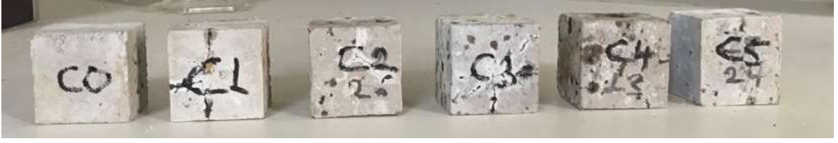
Şekil 4.21: %3 Na 2 SO 4 çözeltisinde 12 hafta bekletilen küp numunelerin görünüşleri
