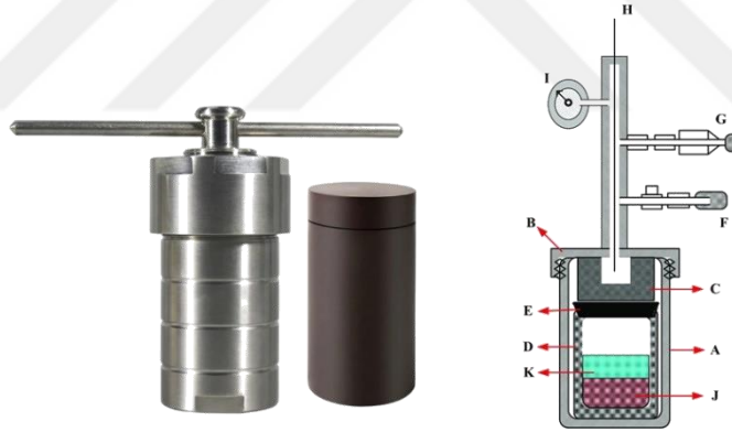
Şekil 3.2 : Hidrotermal karbonizasyon sistemi.
