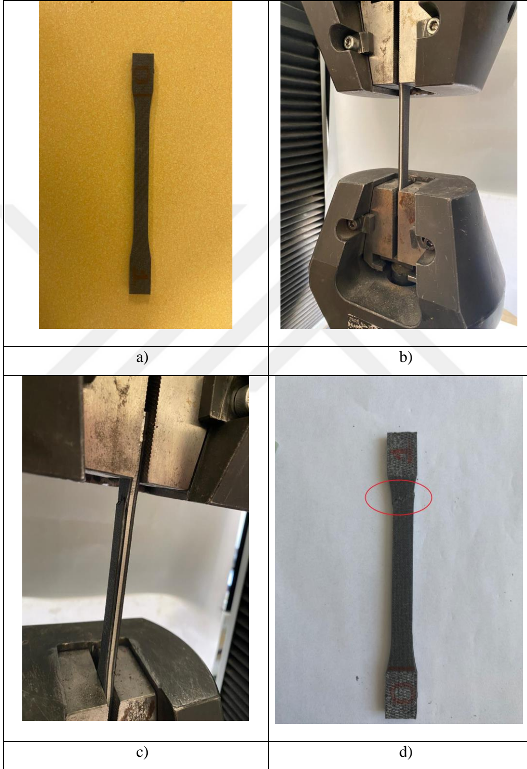
Şekil 5.29: Birinci dizilim numunesi deney a) Öncesi b) Esnasında c) Kopma anı d) Sonuç
