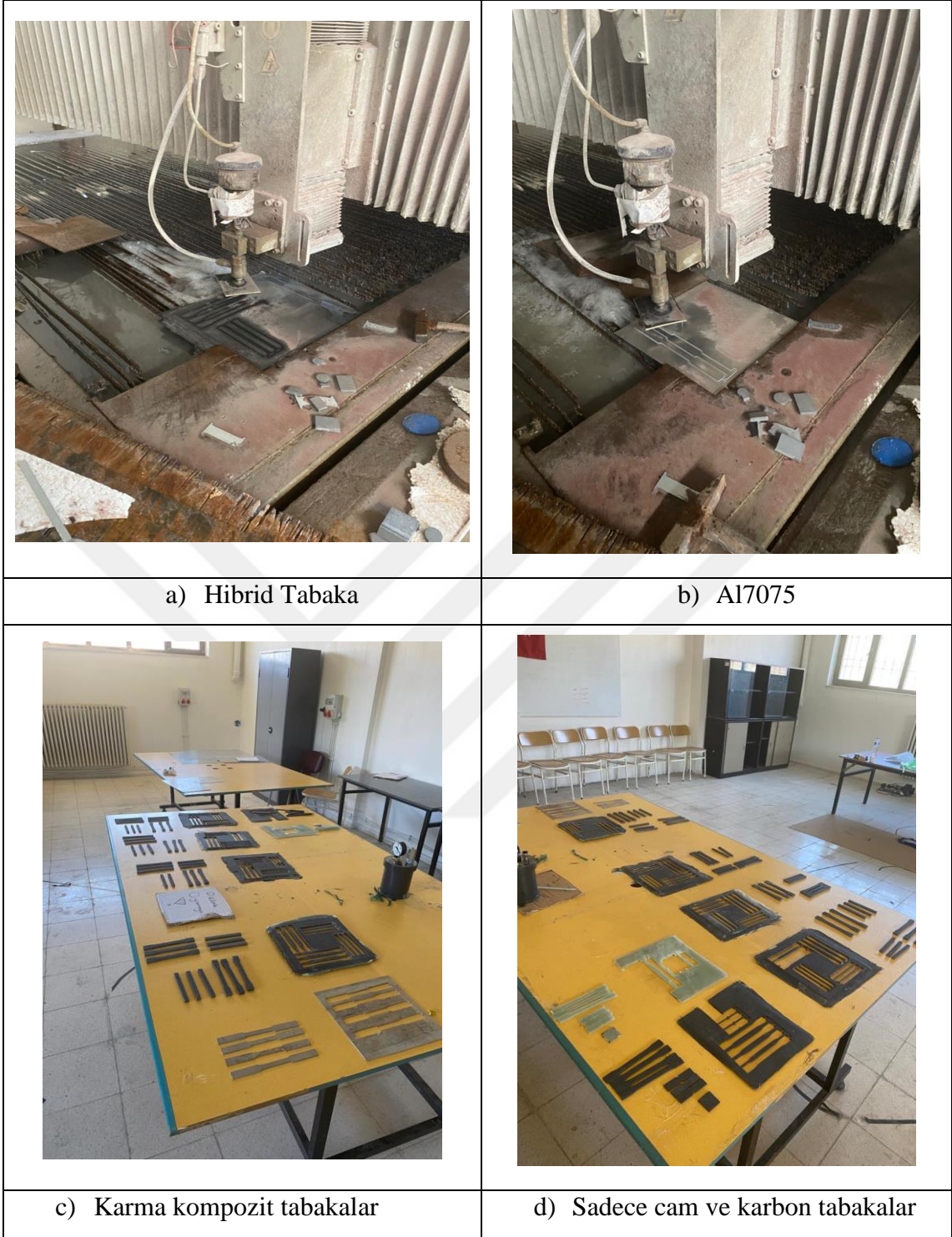
Şekil 4.16: Kompozit ve AL'nin a-b) Su jeti kesimi c-d ) Deney numunlerin görüntüsü
