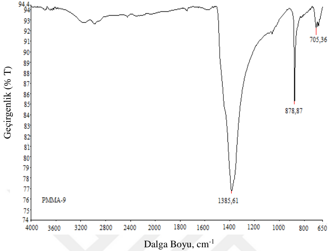
Şekil 4.9 : Karbonizasyon işleminde elde edilen PMMA-9 numunesinin FTIR spektrumu.
