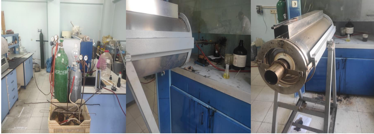
Şekil 3.2 : Deneysel çalışmalar için kullanılan deney düzeneğinin görüntüleri; (solda) silindirik borsal fırına azot gazı akışını sağlayan azot gazı tüpü(yeşil) ve akış ölçer, (ortada) silindirik borsal fırının çıkış kısmına bağlanan geri soğutucu ve piroliz sıvısının toplandığı beher, (sağda) silindirik borsal fırın.
