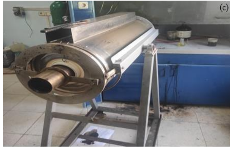
Şekil 3.2: Deneysel çalışmalar için kullanılan deney düzeneğinin görüntüleri; (a) silindirik borsal fırına azot gazı akışını sağlayan azot gazı tüpü(yeşil) ve akış ölçer, (b) silindirik borsal fırının çıkış kısmına bağlanan geri soğutucu ve piroliz sıvısının toplandığı beher, (c) silindirik borsal fırın.
