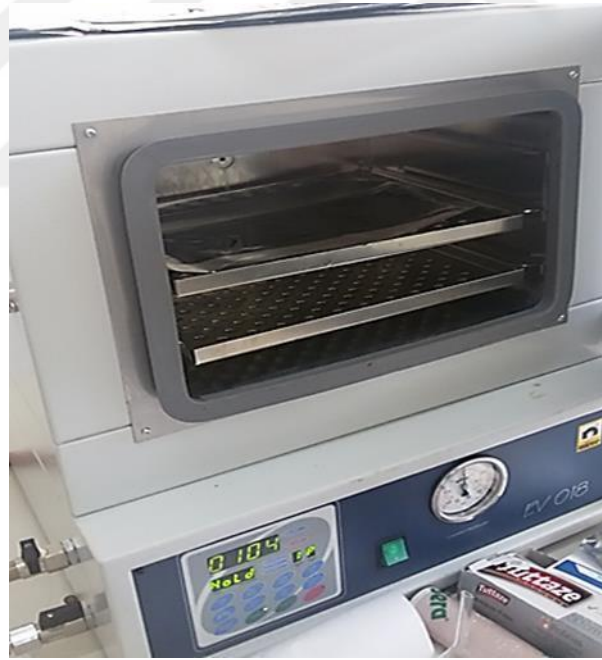
Şekil 4.14: Kaplanan filmlerin vakumlu etüvde kurutulması işlemi.
