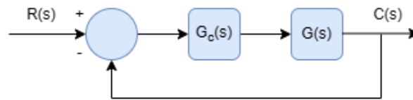
Şekil (3.2.1.4): Örnek 2 İçin Verilen Sistemin Blok Diyagramı
