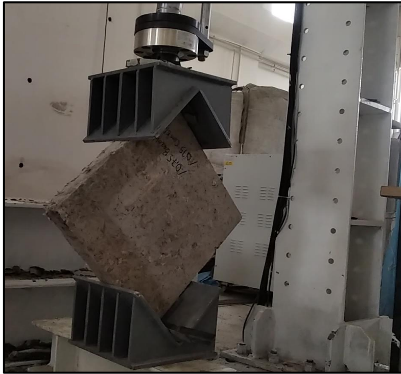
Şekil 4.22: Hacimce % 0,75 Bazalt + % 0,75 Cam Elyaf lif içeren plağın kırılmaya başladığı an
