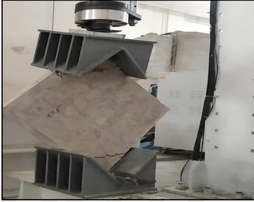
Şekil 4.18: Lifsiz plağın kırılmaya başladığı an
