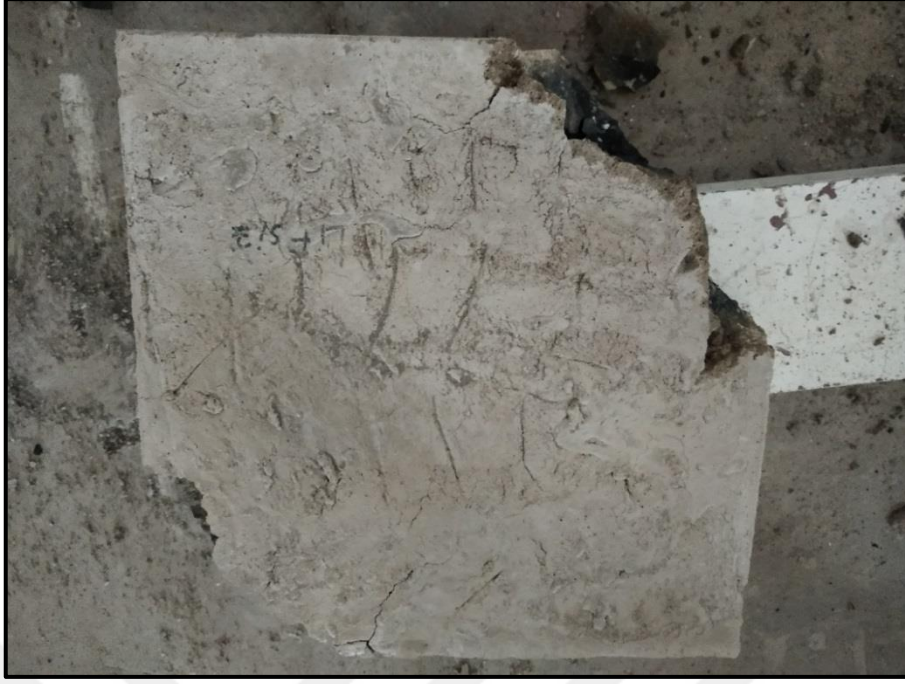
Şekil 4.19: Lifsiz numunenin kırıldıktan sonraki hali
