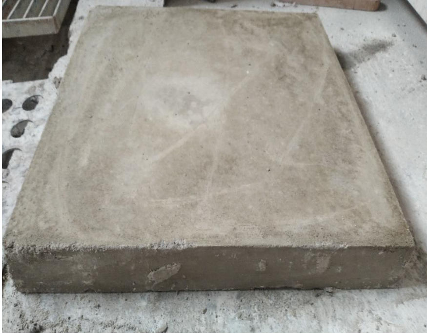
Şekil 3.31: Lifsiz geopolimer beton Plağın kalıptan çıktıktan sonraki hali
