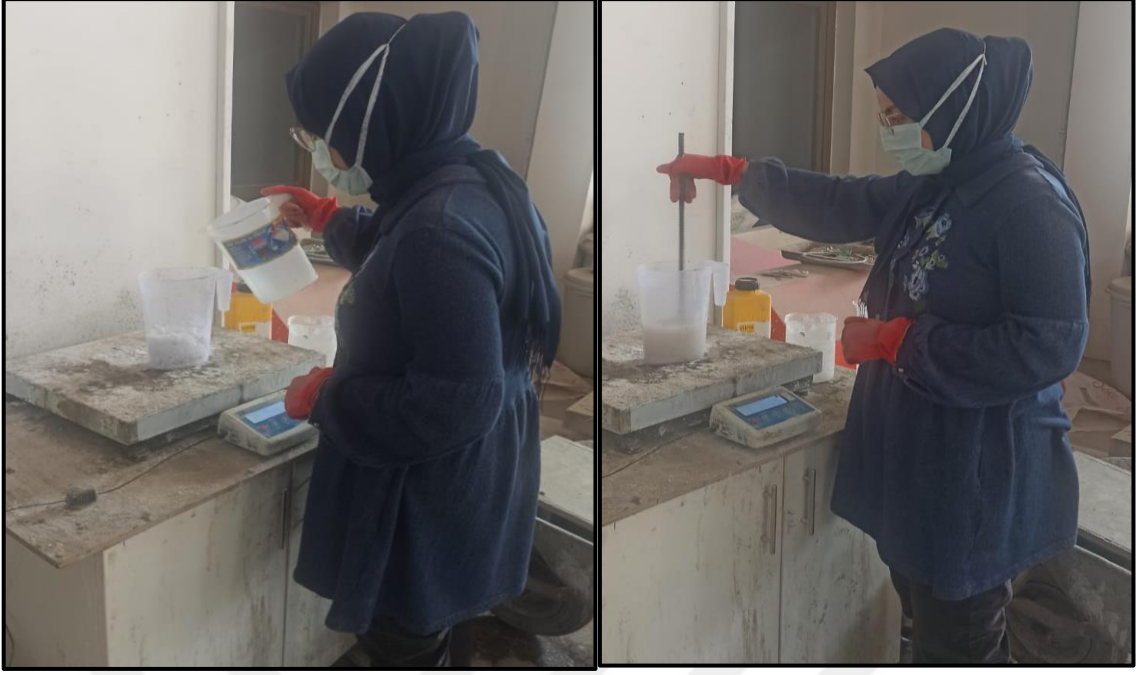
Şekil 3.18: Alkali aktivatörlerin hazırlanması
