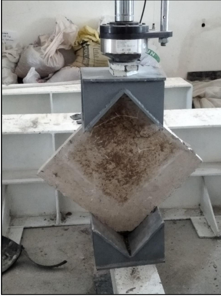
Şekil 3.36: Eğilme deneyi için yerleştirilmiş örnek plak numunesi
