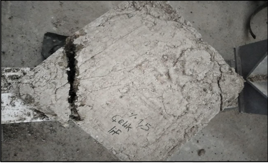
Şekil 4.27: Hacimce % 1,5 Çelik lif içeren numunenin kırıldıktan sonraki hali
