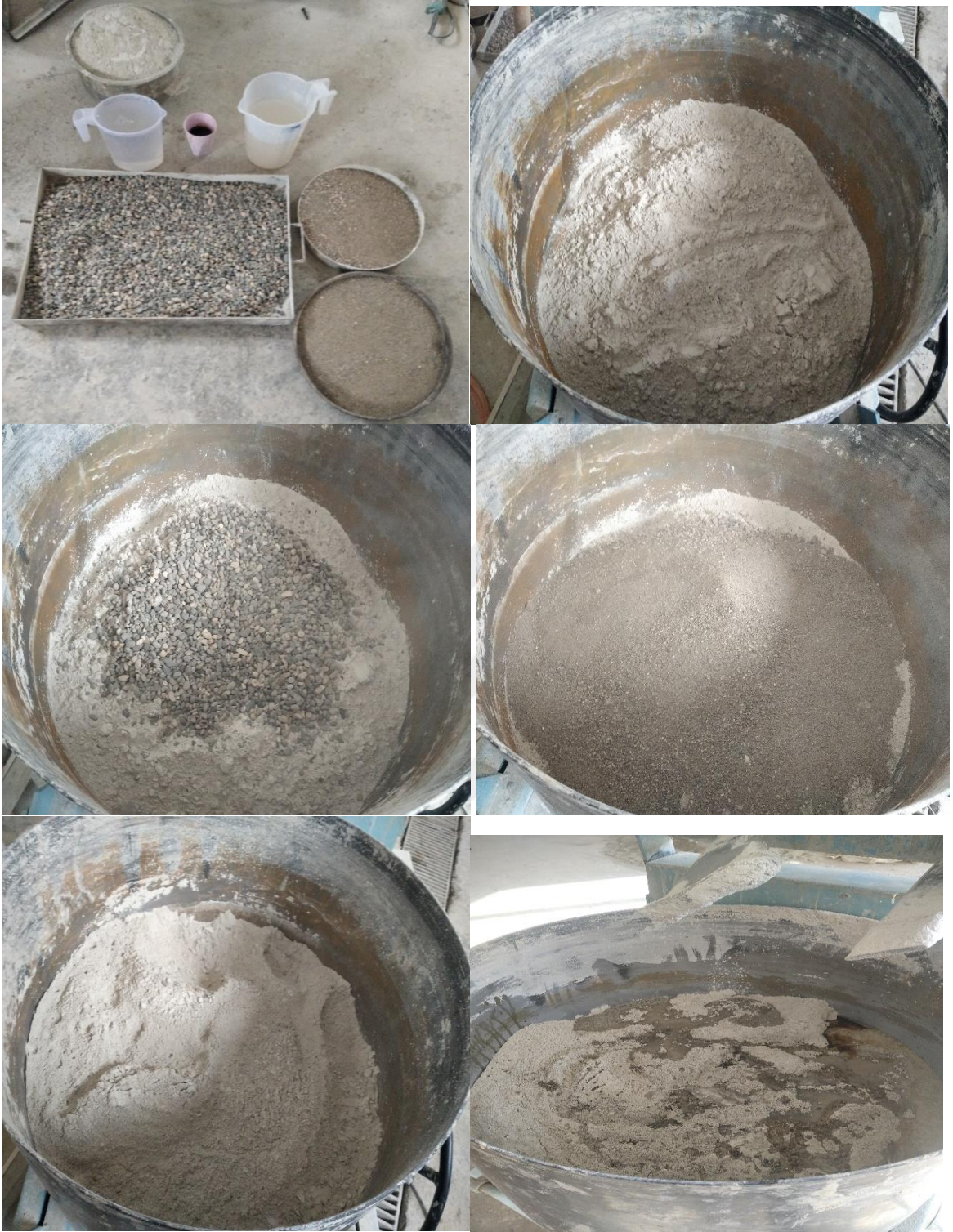
Şekil 3.30: Lifsiz geopolimer plak üretim aşamaları
