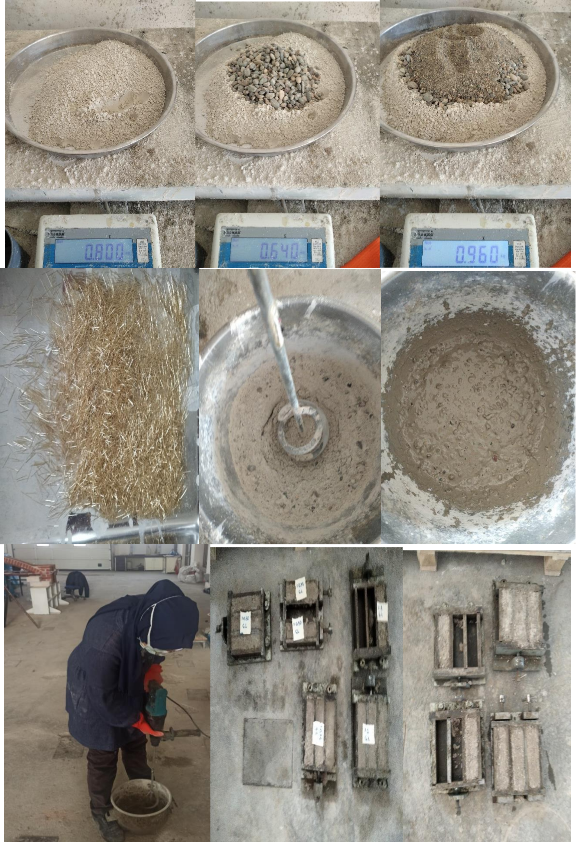
Şekil 3.26: Çelik lif içeren geopolimer numunelerin hazırlanması
