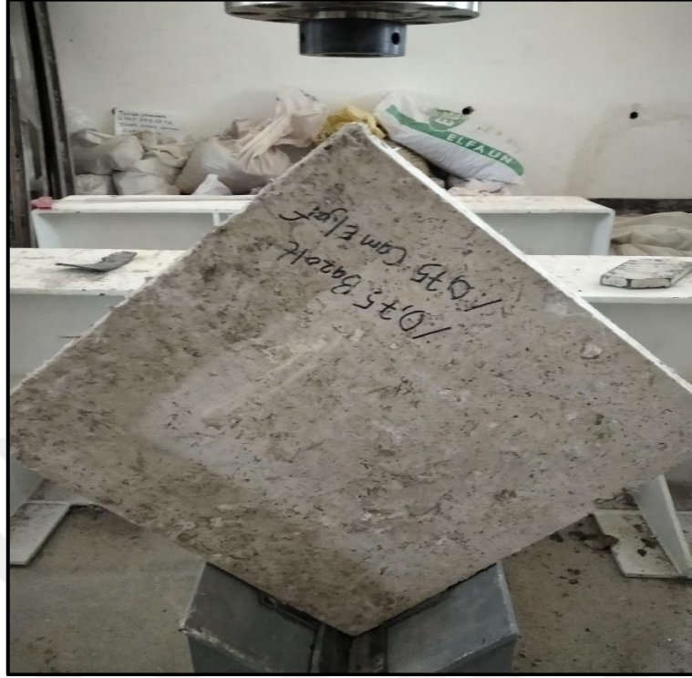
Şekil 4.21: Hacimce % 0,75 Bazalt + % 0,75 Cam Elyaf lif içeren plağın kırımdan önceki hali
