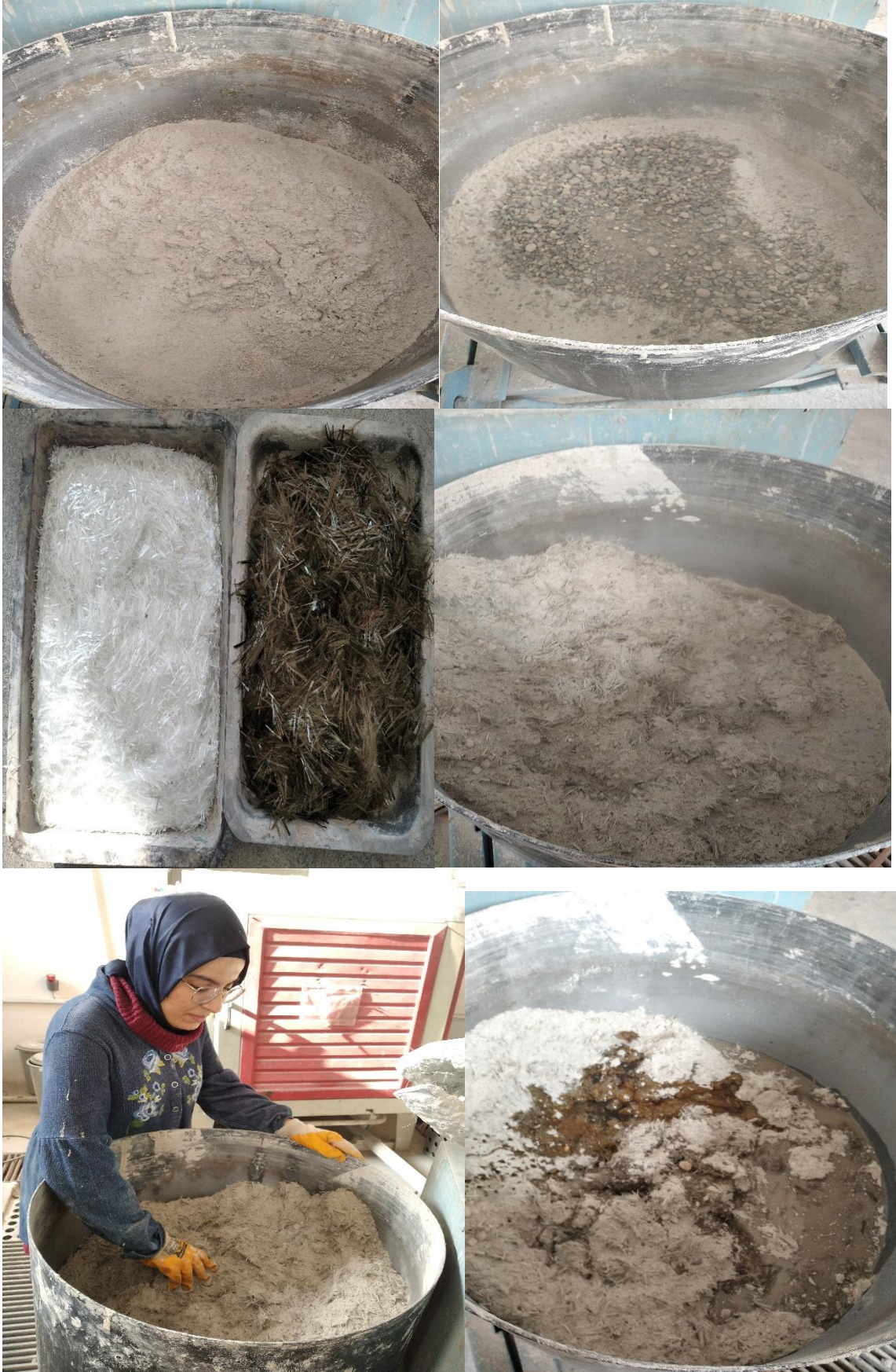
Şekil 3.32: Bazalt+Cam elyaf içeren geopolimer beton plak üretim aşamaları
