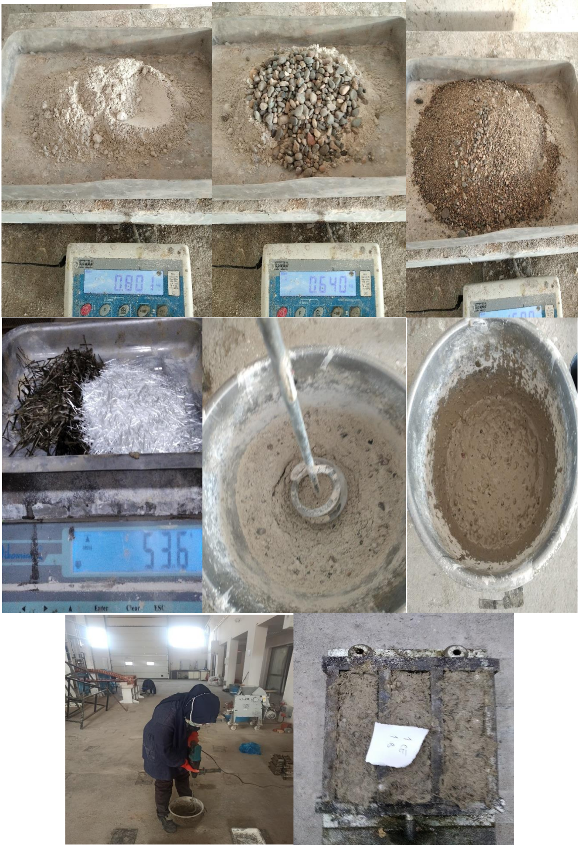
Şekil 3.24: Bazalt + Cam elyaf lif içeren geopolimer numunelerin hazırlanması
