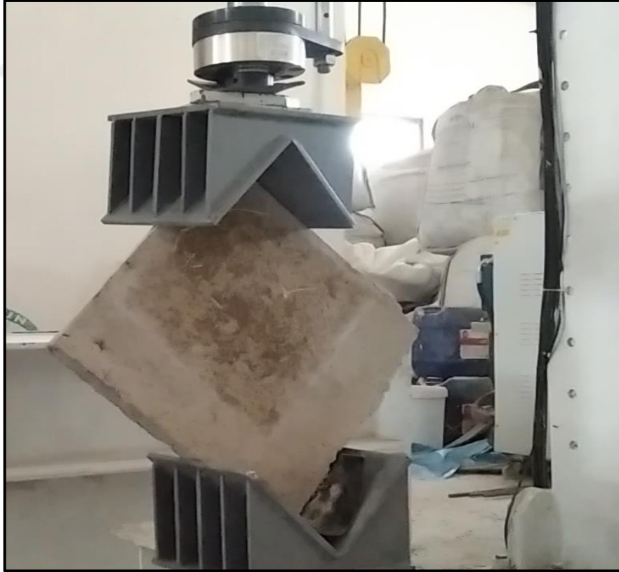
Şekil 4.26: Hacimce % 1,5 Çelik lif içeren plağın kırılmaya başladığı an
