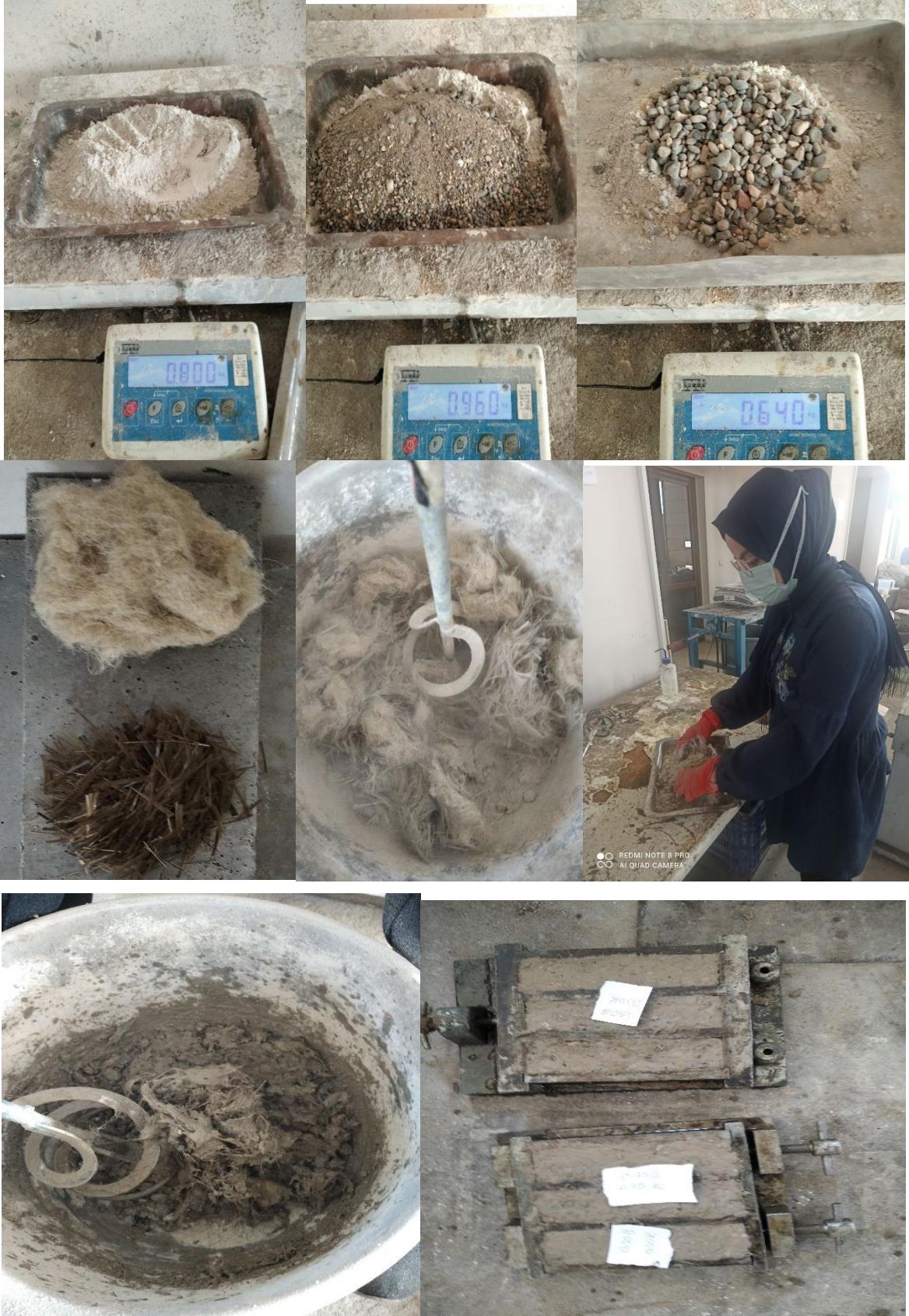
Şekil 3.22: Kenevir + Bazalt lif içeren geopolimer numunelerin hazırlanması
