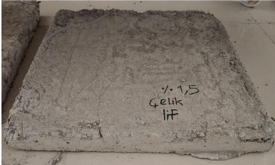
Şekil 3.35: Çelik Lif içeren geopolimer beton plağın kalıptan çıktıktan sonraki hali
