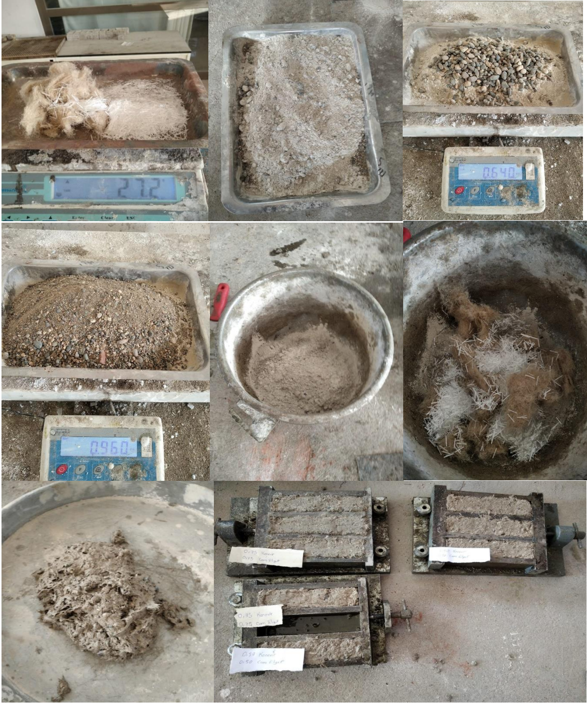
Şekil 3.20: Kenevir + Cam elyaf lif içeren geopolimer numunelerin hazırlanması
