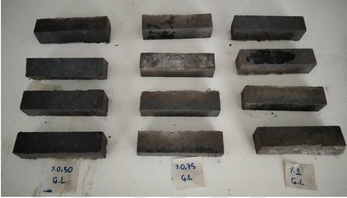
Şekil 3.27: Çelik lif içeren geopolimer numunelerin kalıptan çıkmış hali
