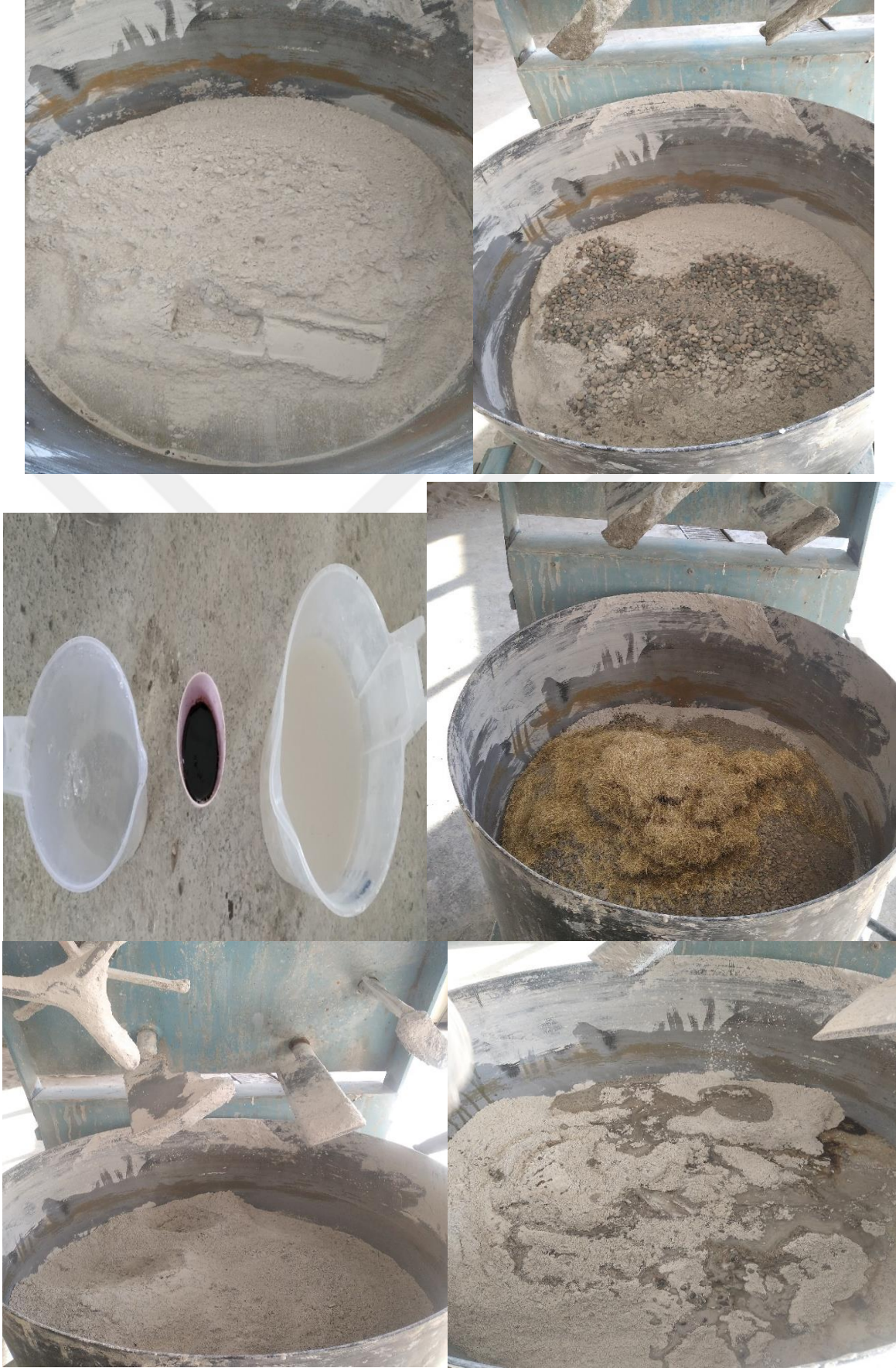
Şekil 3.34: Çelik Lif içeren geopolimer beton plak üretim aşamaları
