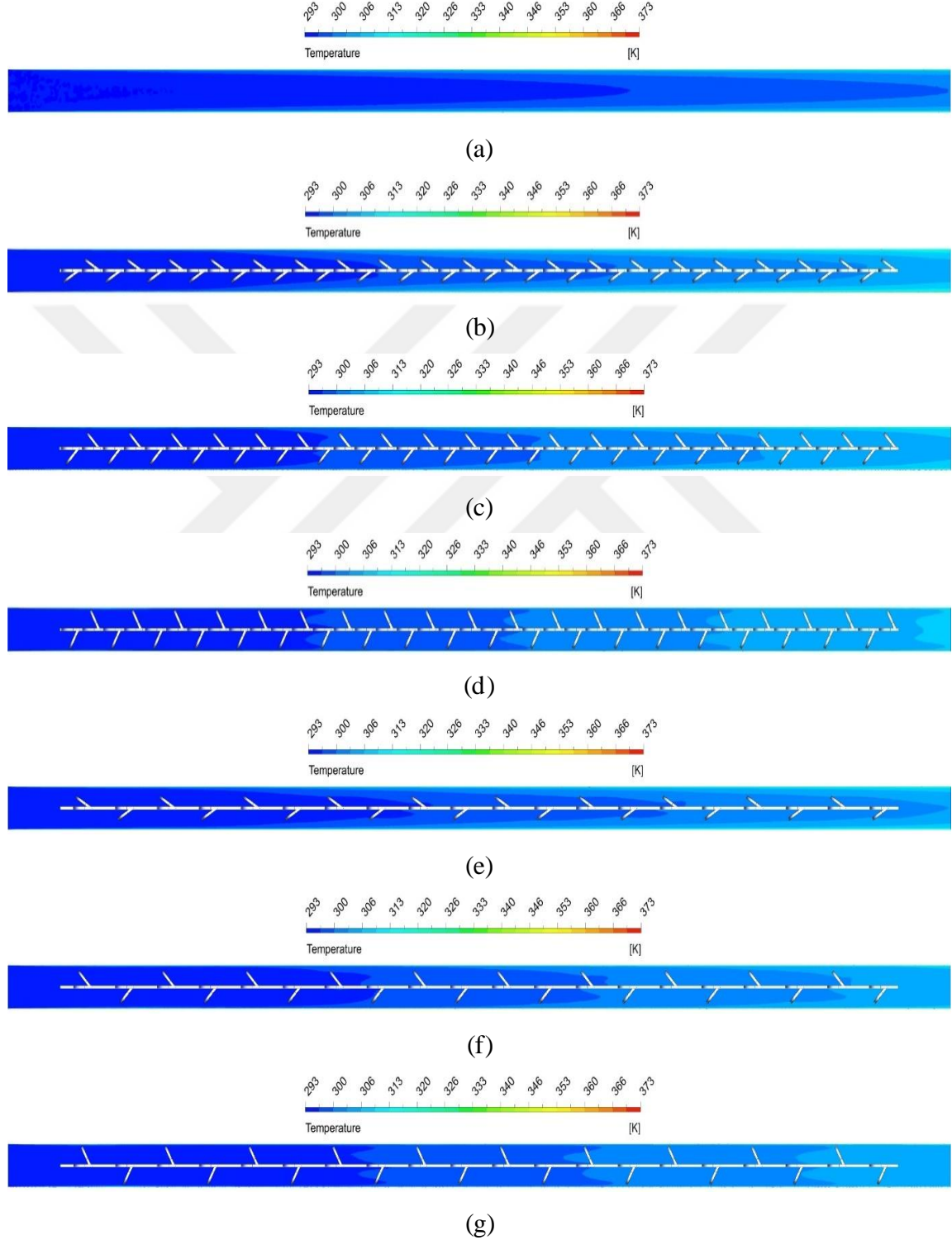
řekil 6.9 : Boř boru ve Model-A türbülator kullanılan borulardaki sıcaklık dađılımı: a. Boř boru. b. P10-30°. c. P10-45°. d. P10-60°. e. P20-30°. f. P20-45°. g. P20-60°.
