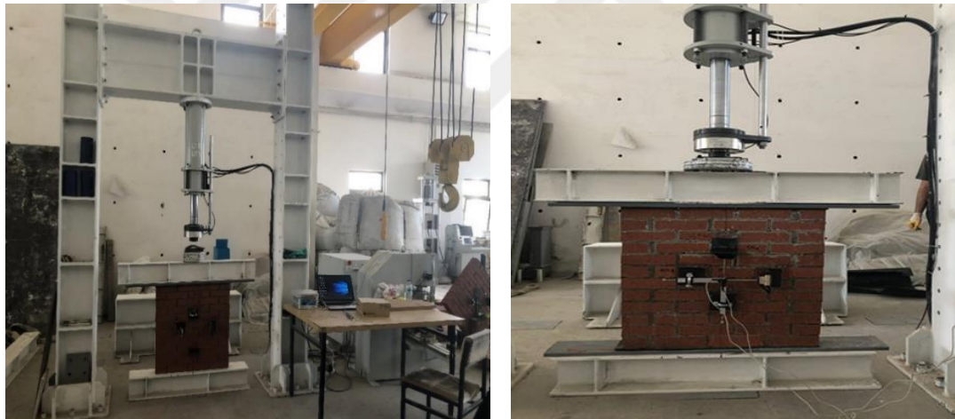
Şekil 3.21 : Aksel basınç dayanımı deney düzeneği
