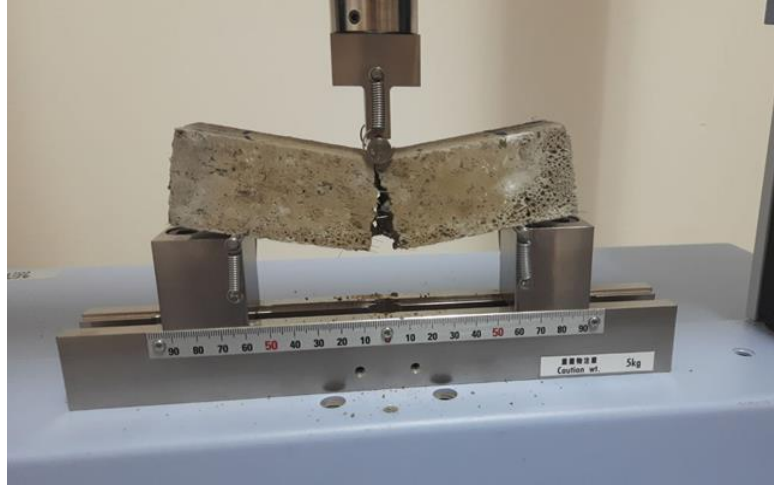
Şekil 3.16 : Eğilme dayanımı test cihazı
