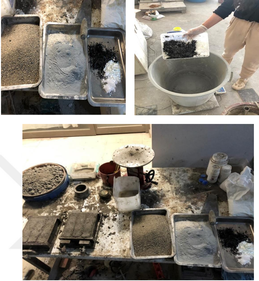
Şekil 3.7 : Lifli geopolimer numunelerin hazırlanması
