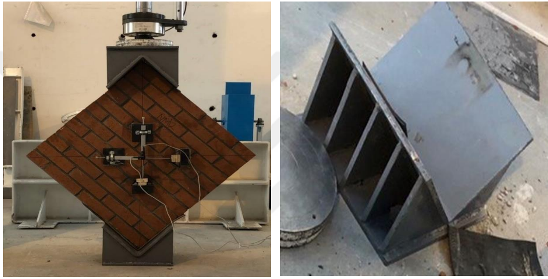
Şekil 3.22 : Diyagonal yükleme düzeneği ve diyagonal yükleme başlığı
