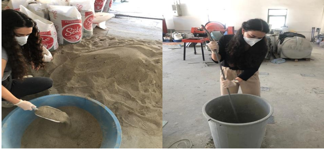
Şekil 3.10 : Kuru harç karışımının hazırlanması
