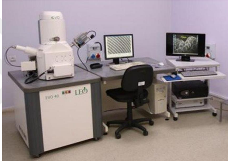
Şekil 3.18 : LEO (Zeiss) EVO40 SEM-EDX cihazı
