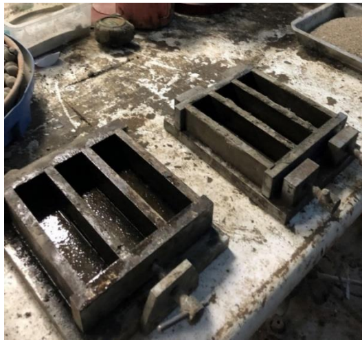
Şekil 3.15 : Eğilme dayanımı deneyi için hazırlanan numunelerin kalıplara yerleştirilmesi
