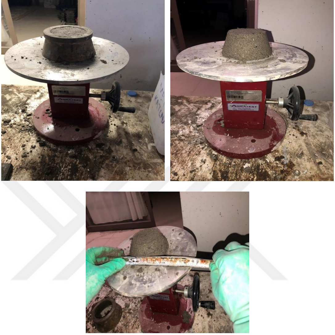
Şekil 3.13 : Yayılma tablası deneyine ait görüntüler
