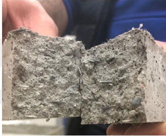
Şekil 3.17 : Eğilme deneyi sonrası lifli numunenin kırılmış görüntüsü
