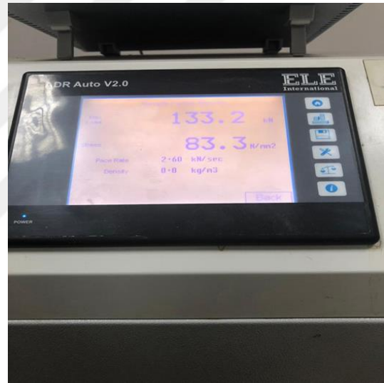
Şekil 3.14 : Basınç dayanımı test cihazı
