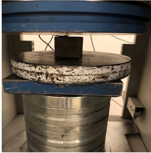
Şekil 3.14 : Basınç dayanımı test cihazı
