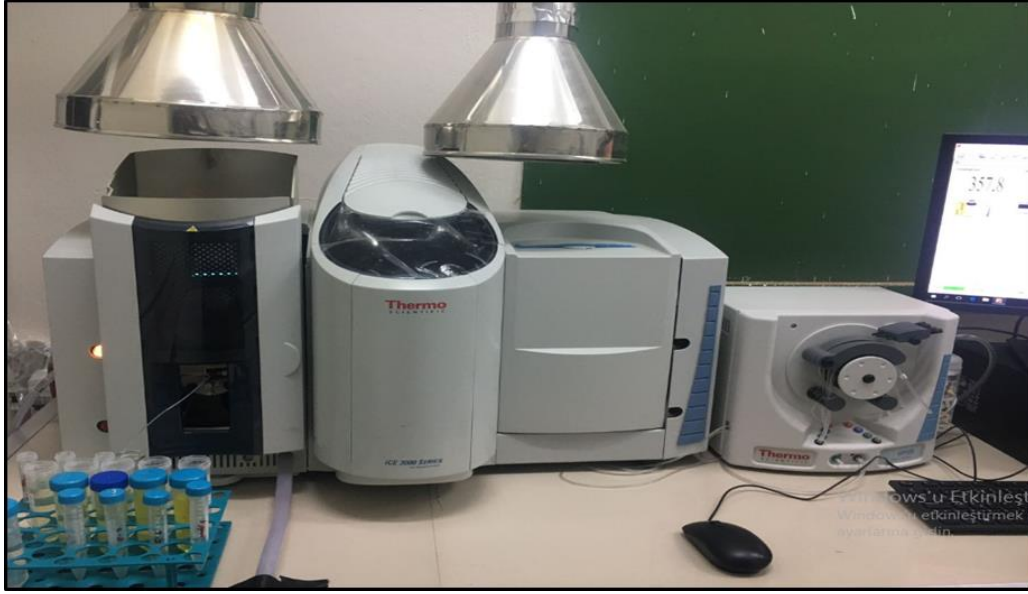
Şekil 3.1: Pb 2+ iyonlarının derişiminin ölçülmesinde kullanılan FAAS.
