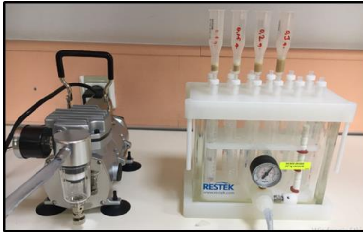
Şekil 3.2: Kolon çalışmalarında kullanılan SPE sistemi.
