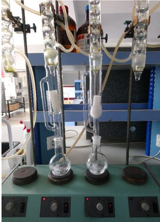
Şekil 4.3 : Yağ tayini için kurulan Sokselet düzeneği.
