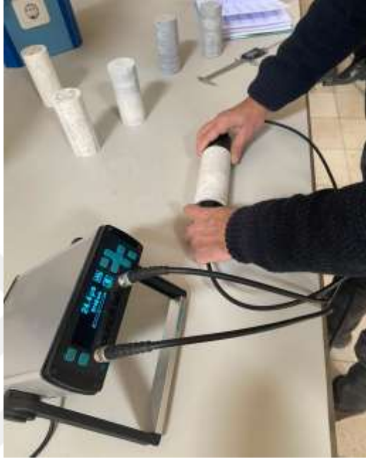
Şekil 3.7. Ultrases geirgenlik hızı cihazı
