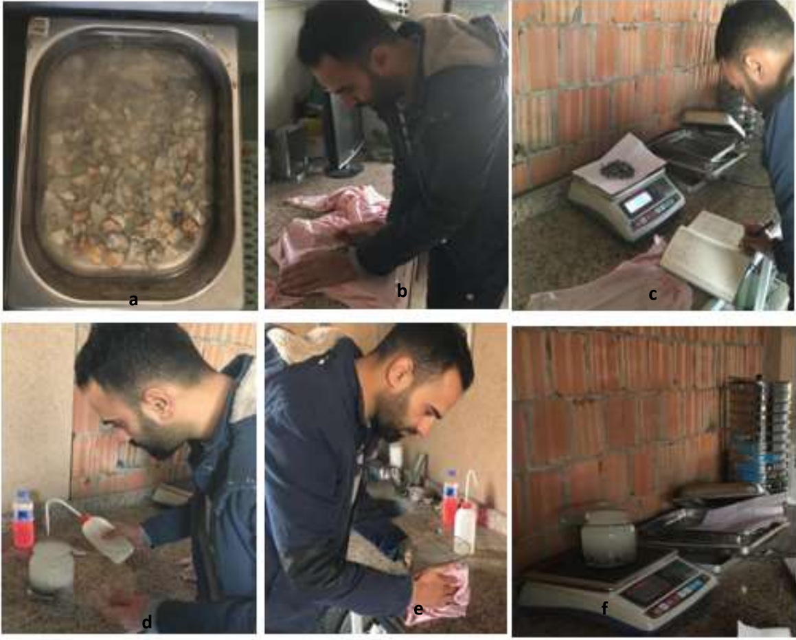
Şekil 3.11. Agrega özgül ağırlık deneyinin yapılışı. a: deneye tabii tutulan numuneler, b:yüzey kurulama işlemi, c: Kurulanan örneklerin tartımı, d: cam kavanozda numuneler, e: cam ile kapatılan numune kavanozu, f: cam kavanozla birlikte tartılan numuneler
