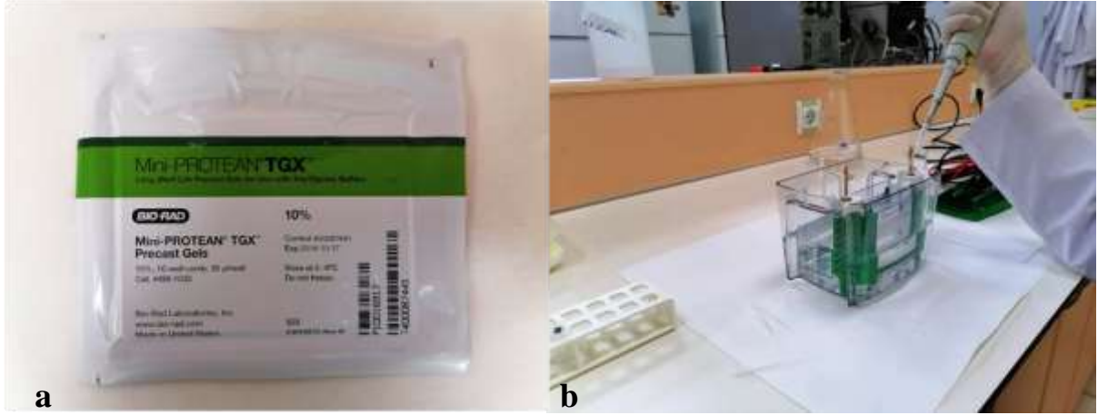
Şekil 3.10 : Doğal poliakrilamid jel elektroforezinde kullanılan hazır jel (a) ve örneklerin kuyucuklara yükleme işlemi (b).
