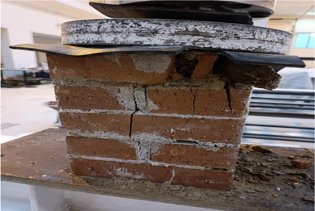
Şekil 4.16 : GHB1 duvar biriminin kırılması
