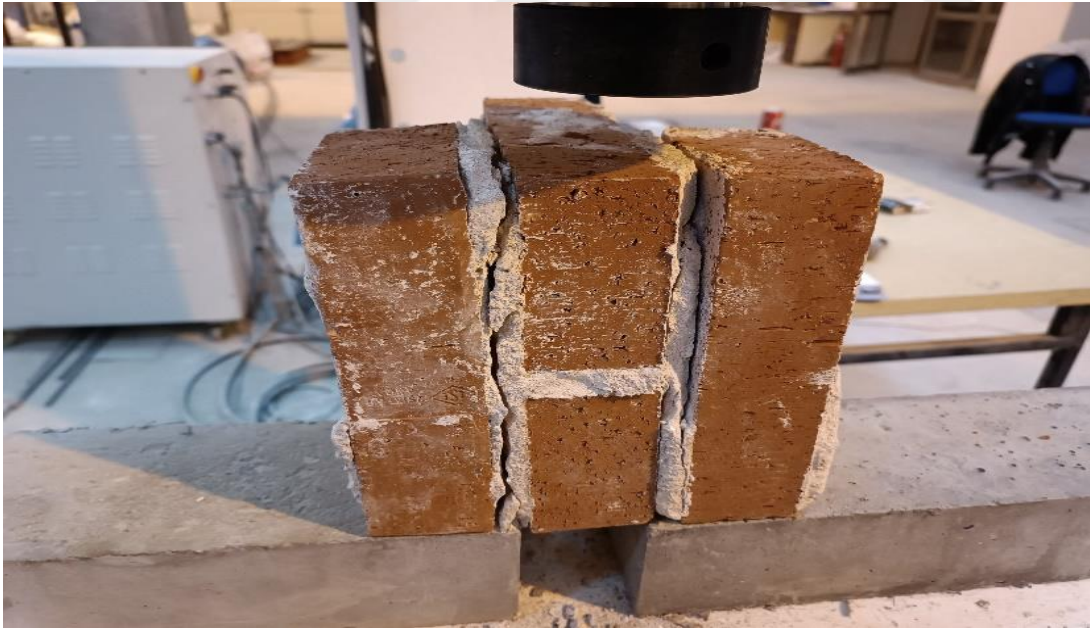
Şekil 4.18 : HK1 duvar biriminin harcının ayrışması
