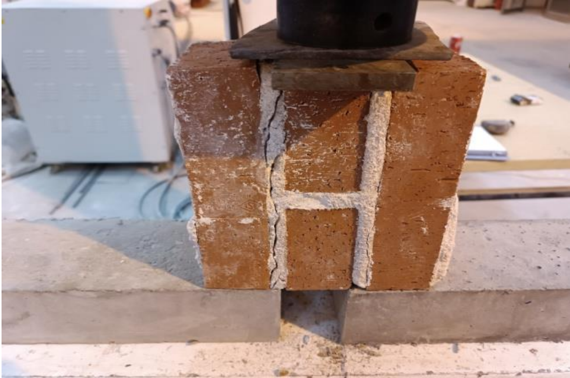
Şekil 3.10 : HK1 duvar biriminin kesme dayanımı testi
