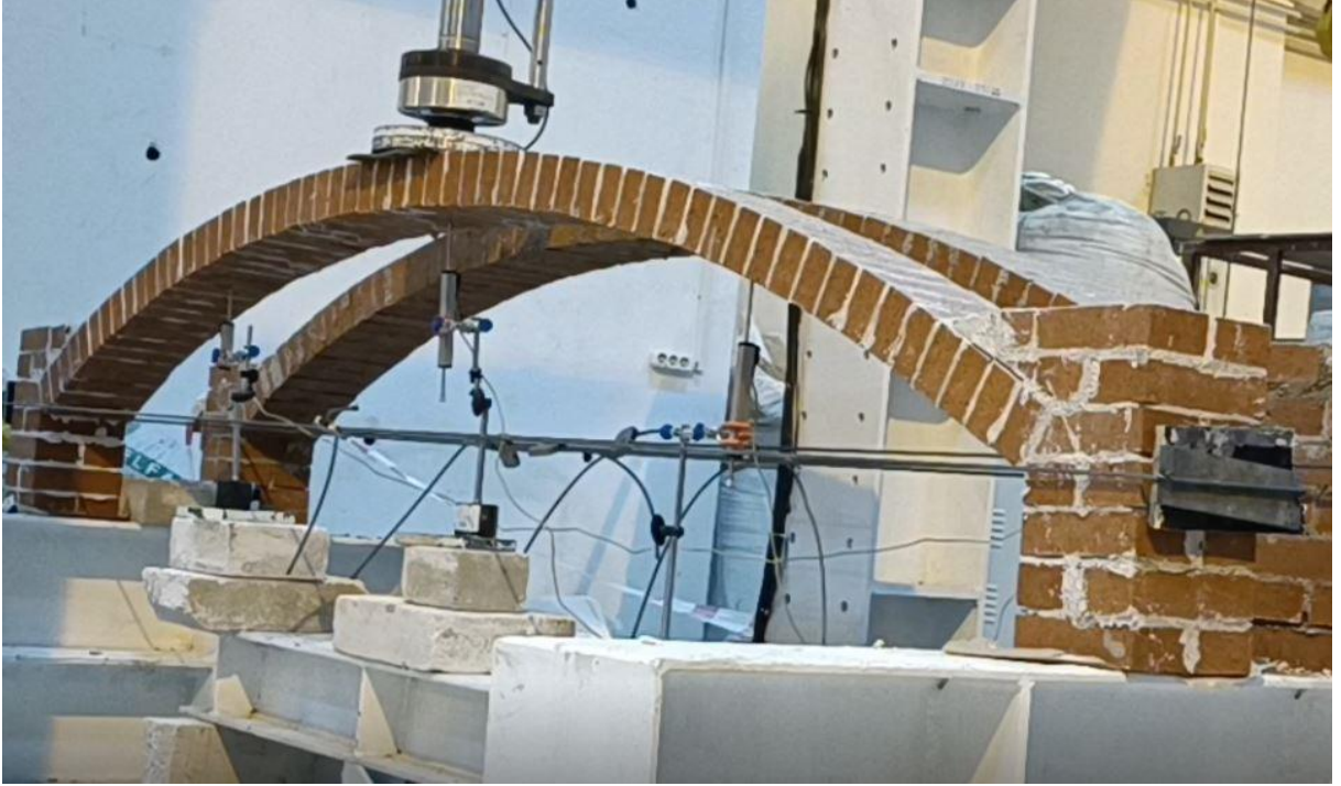
Şekil 3.11 : GHK ve HK kemer sistemlerinin eğilme dayanımı testi
