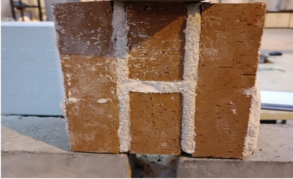
Şekil 3.3 : Standart tarihi yapı harcı kullanılarak basınç dayanımı için üretilen duvar birimi
