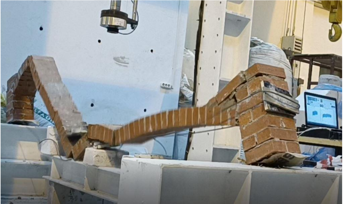
Şekil 4.24 : GHK kemer sisteminin dağılması
