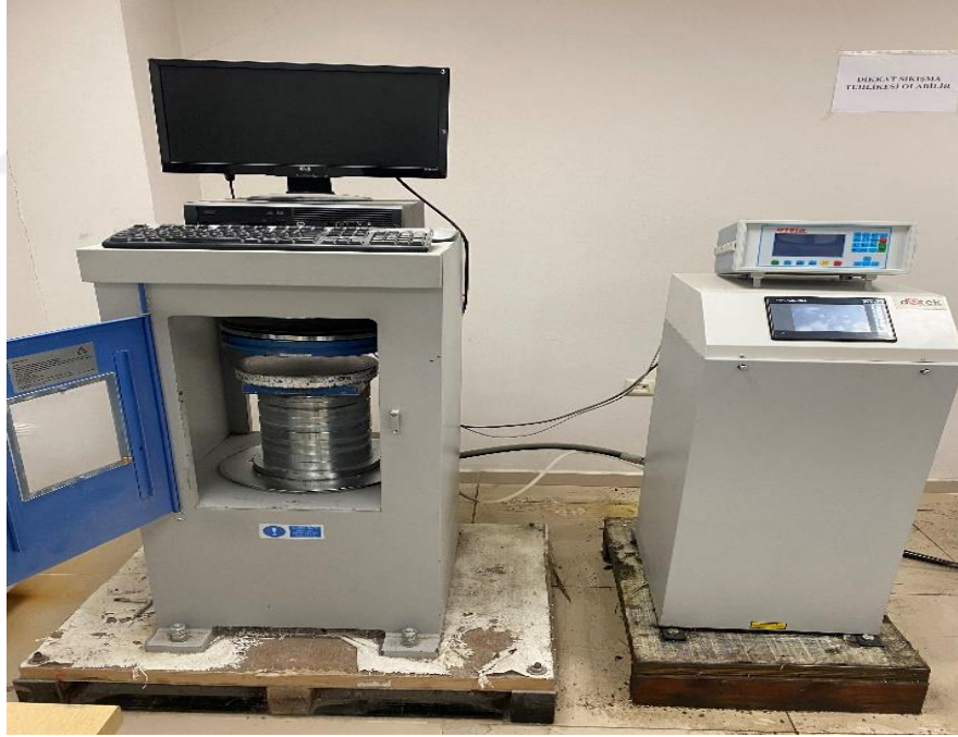
Şekil 3.6 : Basınç dayanımı test cihazı
