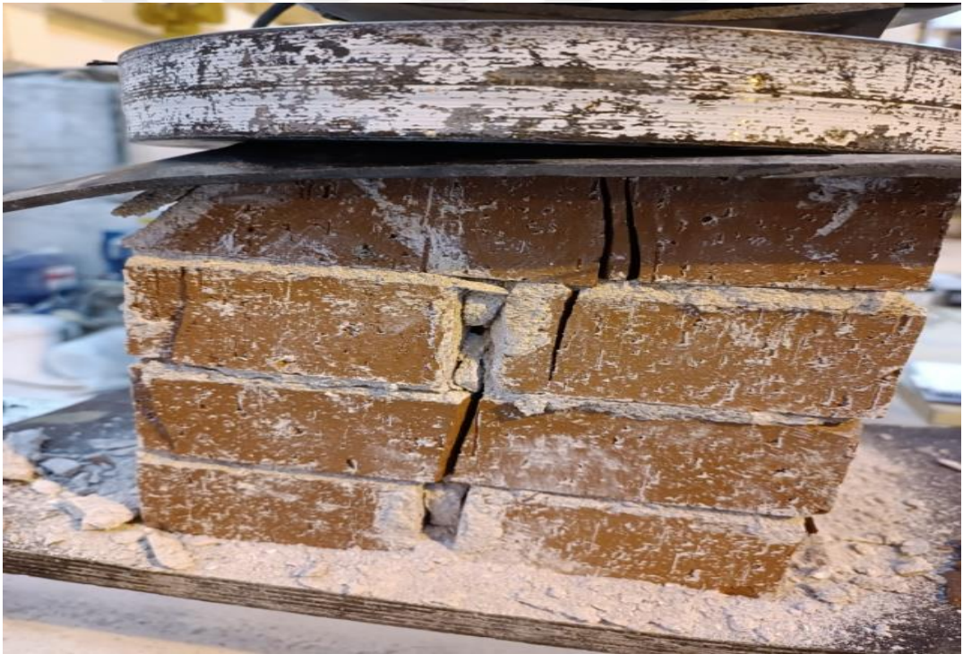
Şekil 3.8 : HB1 duvar biriminin basınç dayanımı testi
