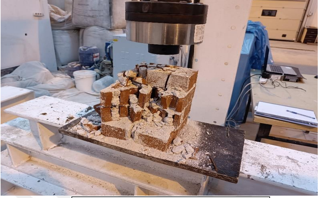
Şekil 4.15 : HB1 duvar biriminin kırılması
