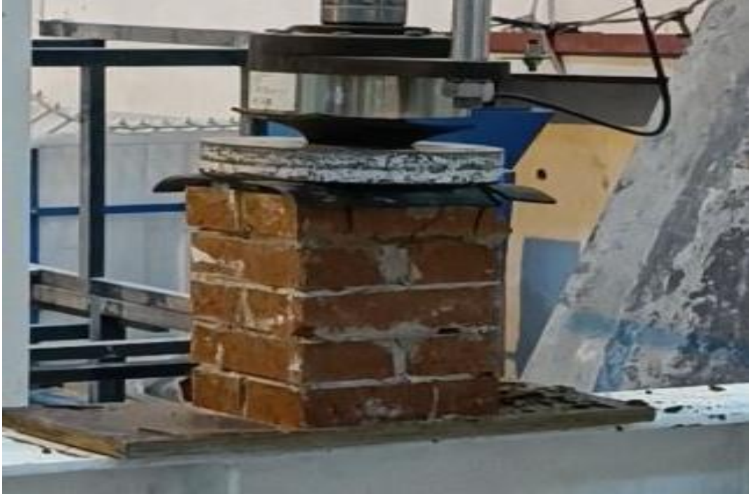
Şekil 3.7 : GHB1 duvar biriminin basınç dayanımı testi
