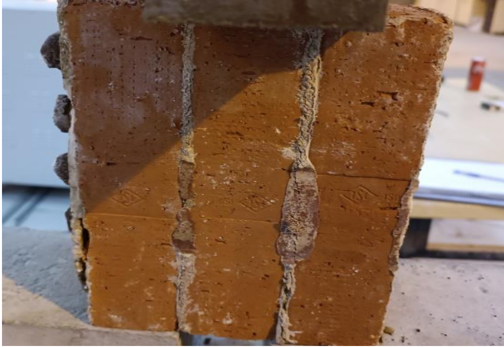
Şekil 3.2 : Geopolimer harç kullanılarak basınç dayanımı testi için üretilen duvar birimi
