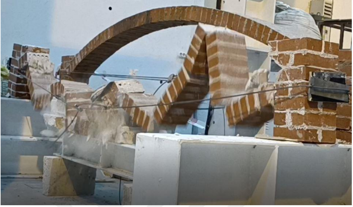
Şekil 4.23 : HK kemer sisteminin dağılması
