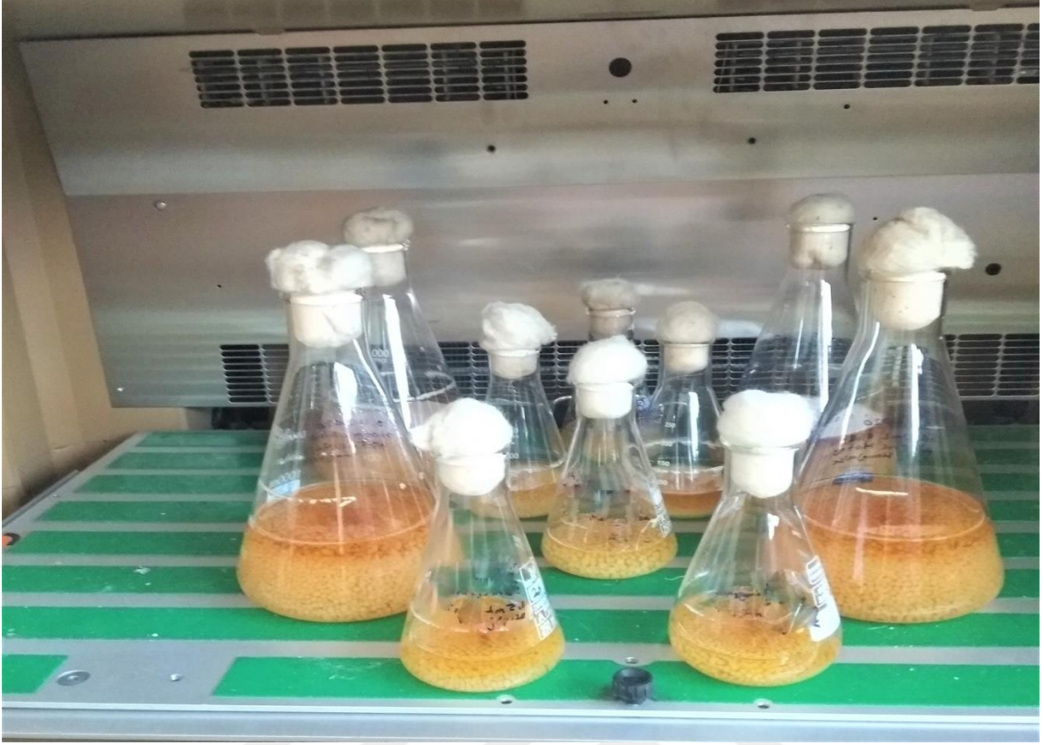
Şekil 3.3: T. versicolor 'un etüvde üretim aşaması
