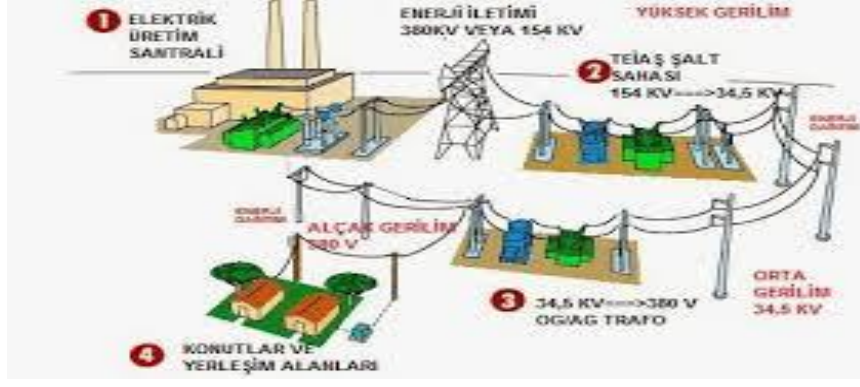
Şekil 2.1: Transformatör iletim ve dağıtım örnek şeması [61].
