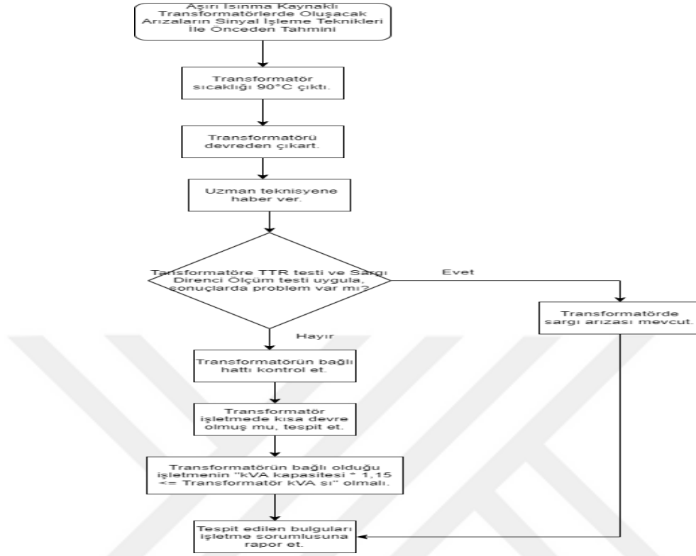
Şekil 3.6: Sinyal izleme yöntemi ile aşırı ısınma kaynaklı oluşacak transformatör arıza tahmin ve tespiti için önerilen algoritma.
