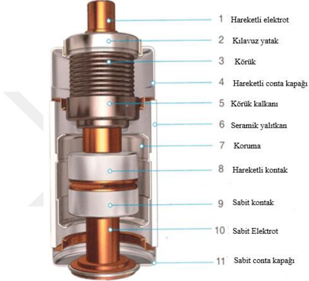
Şekil 3.3: Vakum devre kesicinin iç yapısı [35].
