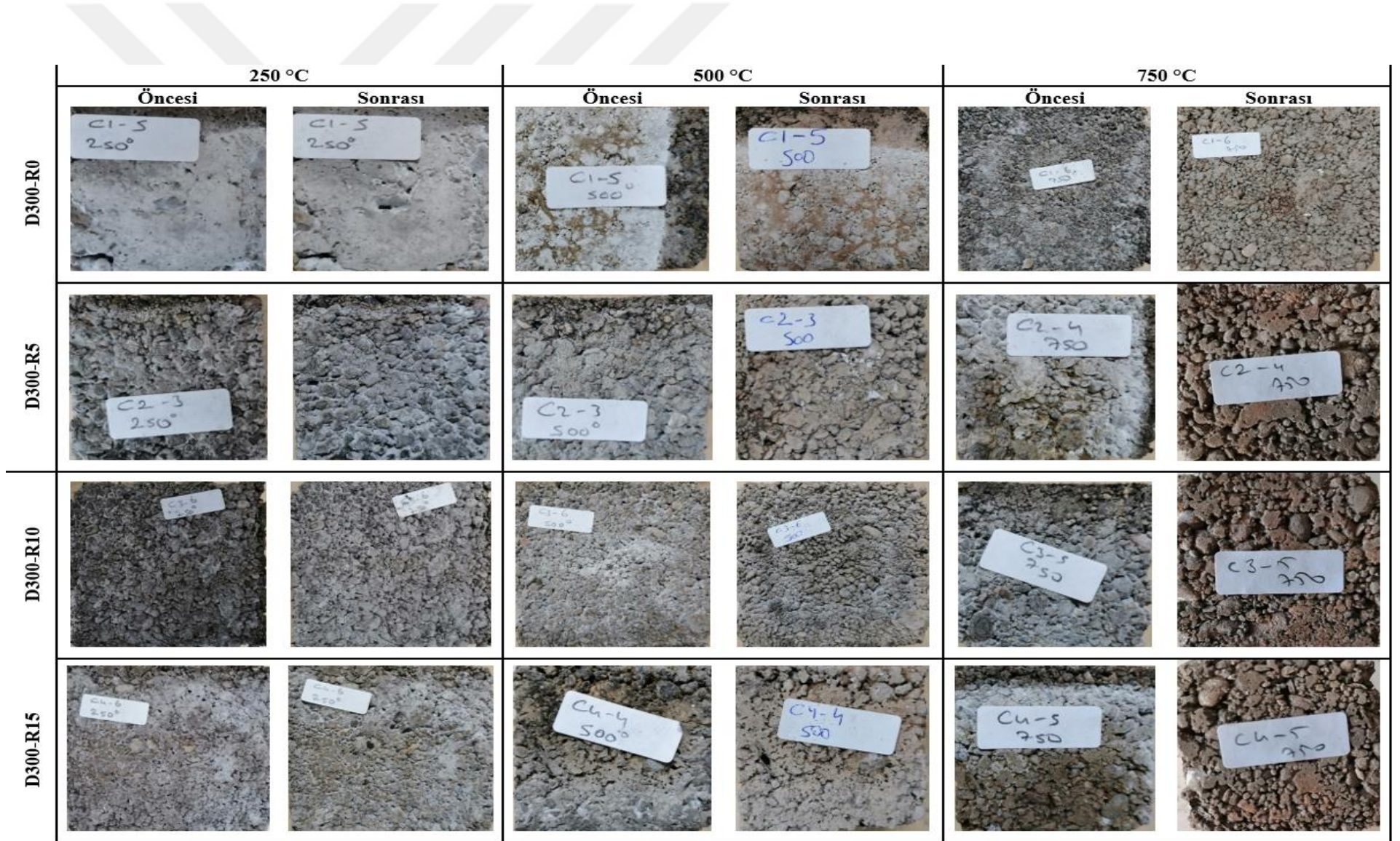
Şekil 4.17: 300 kg/m 3 bağlayıcı dozajı ile üretilen GB numunelerin renk değişimi.
