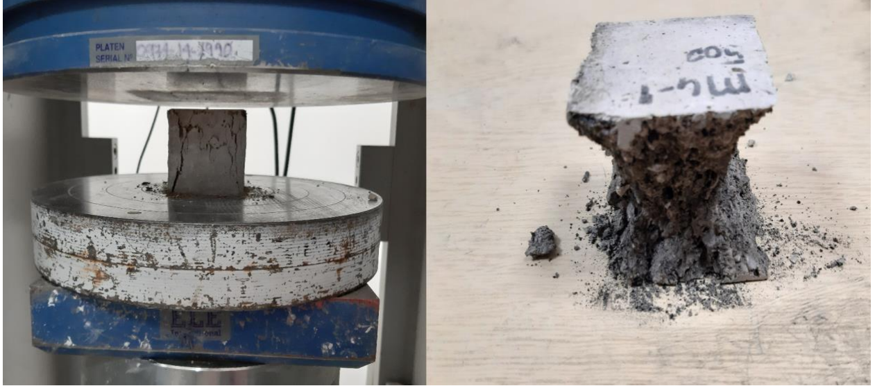
Şekil 3.16 : Deneye tabi tutulan numune ve numunenin kırılma yüzeyleri
