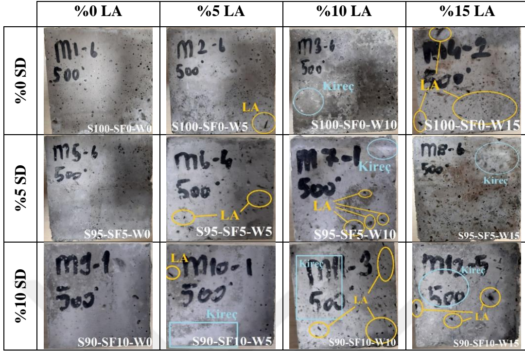
Şekil 4.18 : 500 °C'ye maruz kalan numunelerin görsel analizi
