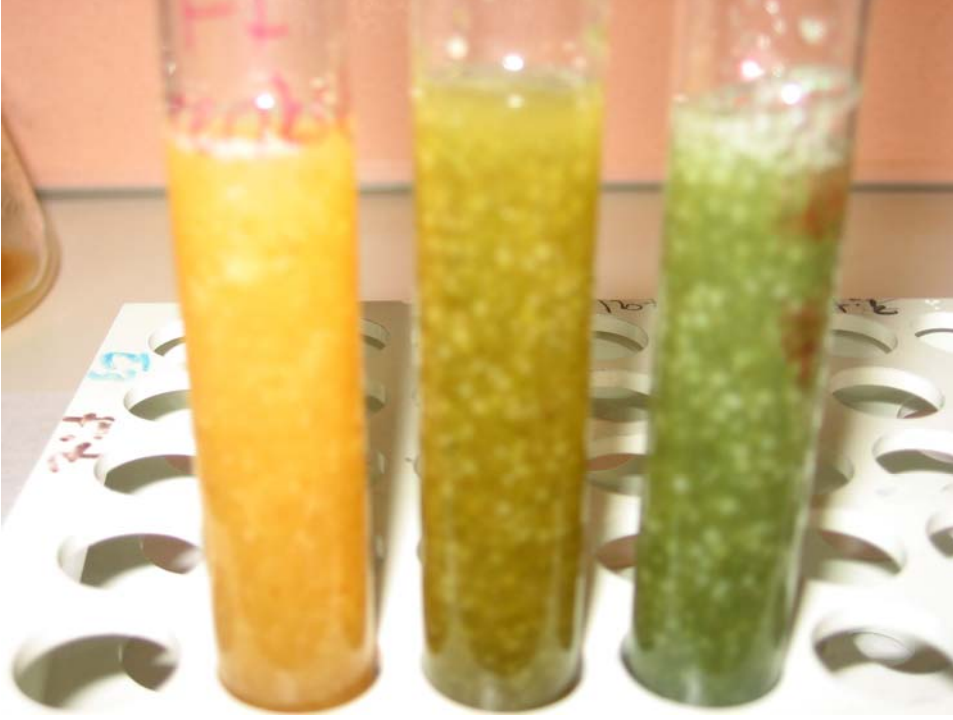
Şekil 4.19. Boyar madde tutundurulmuş kepek eklenen sıvı fermantasyon ortamında renk değişimi
