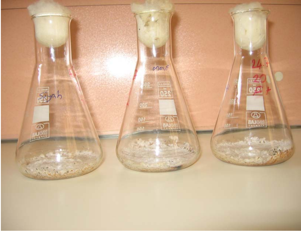
Şekil 4.6. Boyar madde adsorblanmış kepek katı substrat fermantasyonu sürecinde renk giderimi
