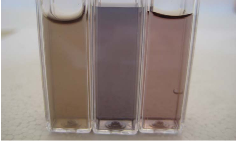
Şekil. 4.35. Ham kültür filtratı (en başta) ve saf lakkaz (en sonda) kullanarak Reaktif siyah 5 boyasının renginin giderimi
