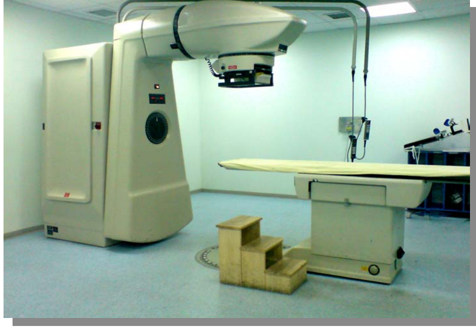
Şekil 3.7.1. Radyasyon uygulamasında kullanılan Kobalt-60 cihazı.
