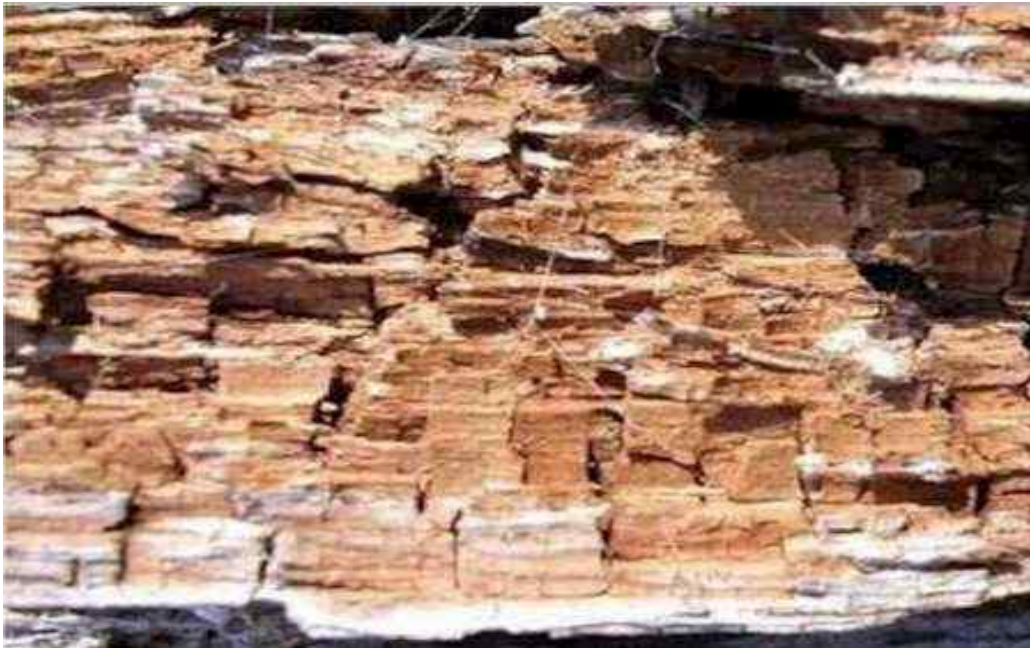
Şekil 1.1. Kahverengi çürükçül fungus tarafından çürütülmüş odunun şekli [28]
