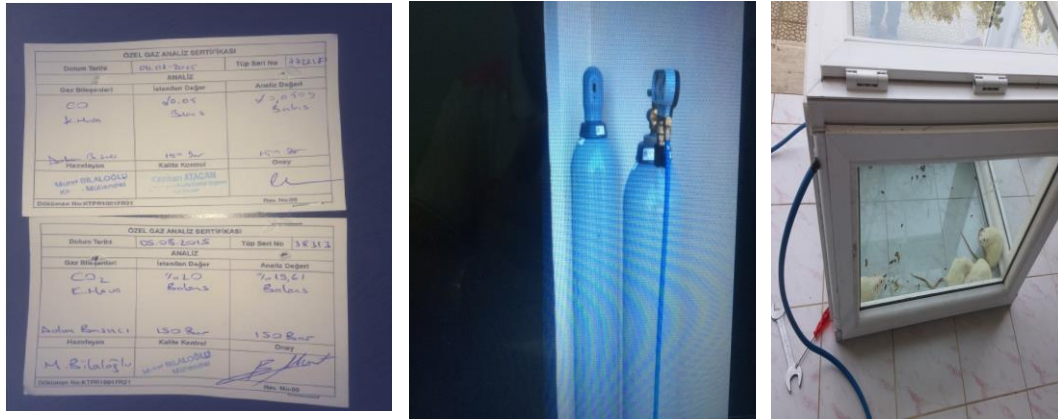
Resim 7: Deneyin yapıldığı izole sistem ve kalite kontrollü sertifikalı CO/ CO 2 tüpleri
