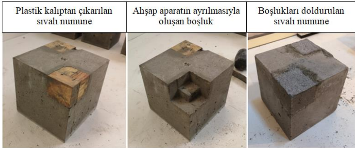
Şekil 4.18 : Ahşap aparatın oluşturduğu boşlukların doldurulma aşamaları.
