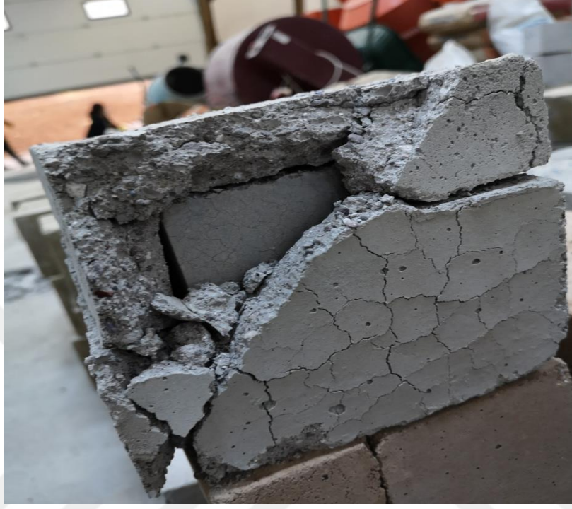
Şekil 4.25 : 700 °C sıcaklığa maruz kalan K-PK grubu sıvalı numune.
