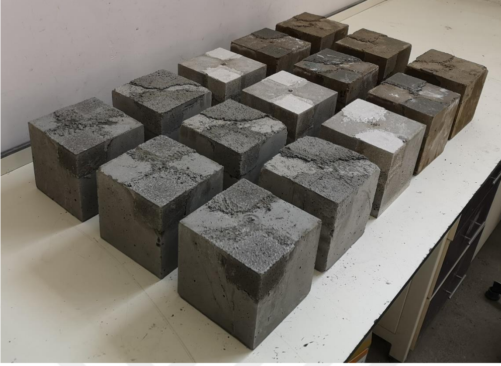
Şekil 4.23 : Boşlukları sıva harçları ile doldurulan numuneler.
