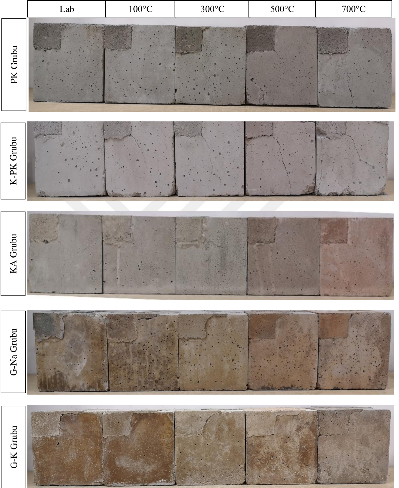
Şekil 4.24 : Sıvalı numunelerin farklı sıcaklıklar etkisi altındaki görünüşleri.
