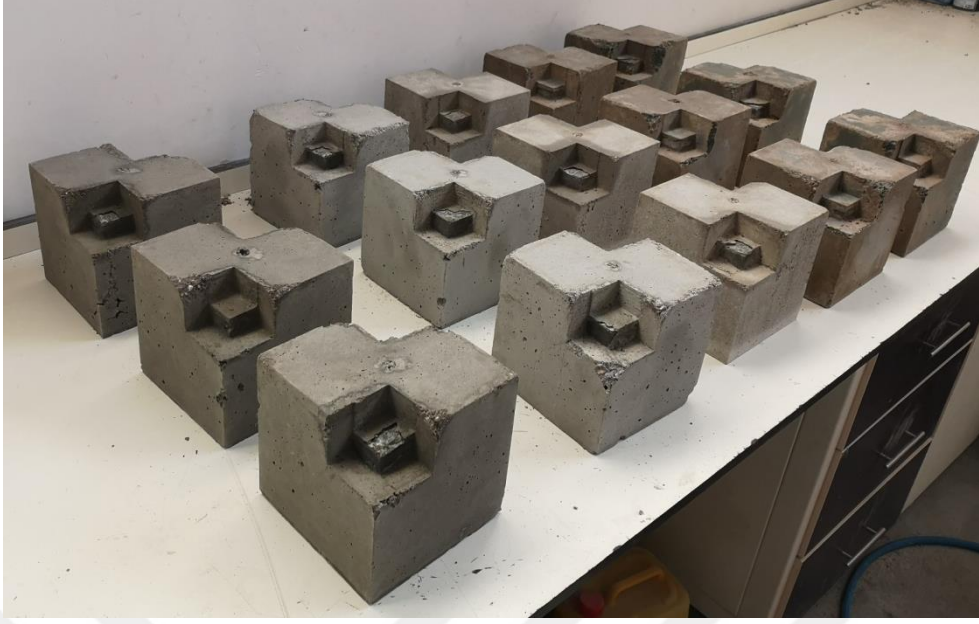
Şekil 4.21 : Ahşap aparatları ayrılan sıvalı numuneler.
