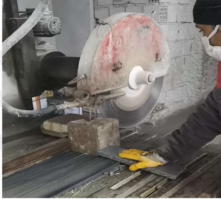
Şekil 3.11 : Sıvalı numunenin kesimi.
