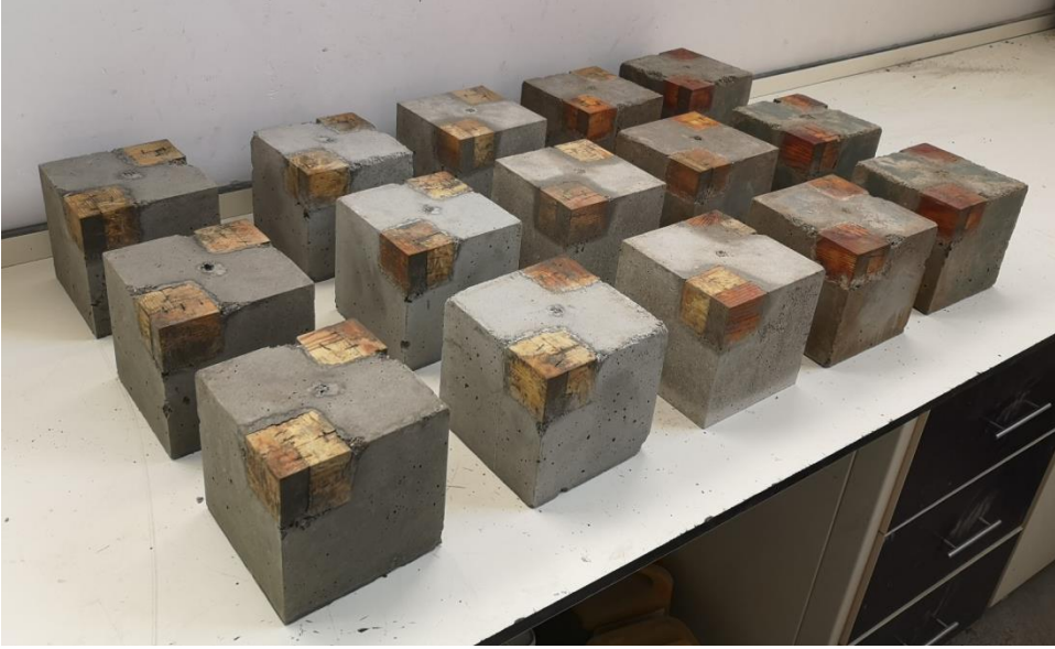
Şekil 4.20 : Plastik kalıptan çıkarılan sıvalı numuneler.
