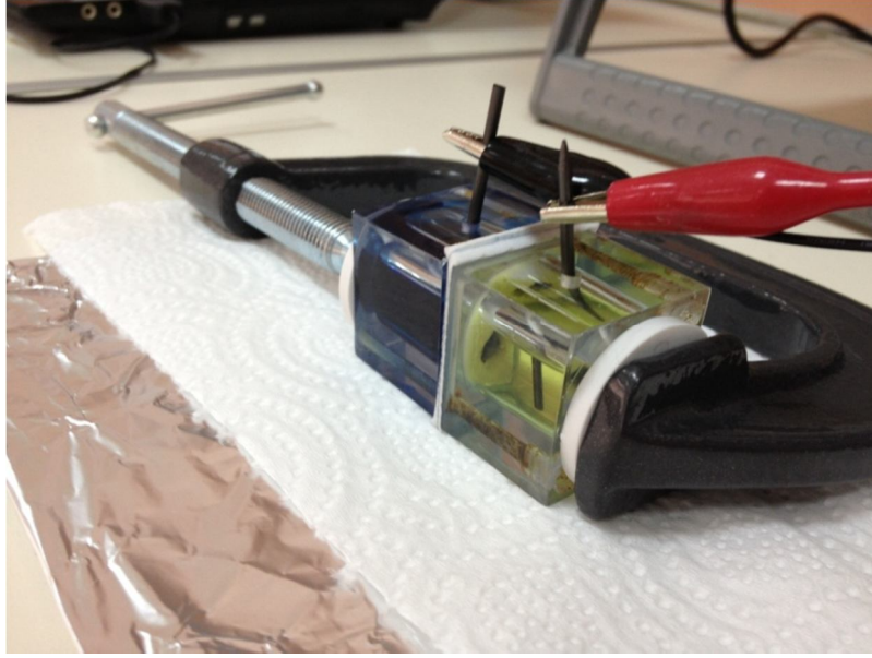
Şekil 3.1. Deneyler süresince kullanılan yakıt pili. Sarı renk: katot bölümünü, mavi renk: anot bölümünü göstermektedir.
