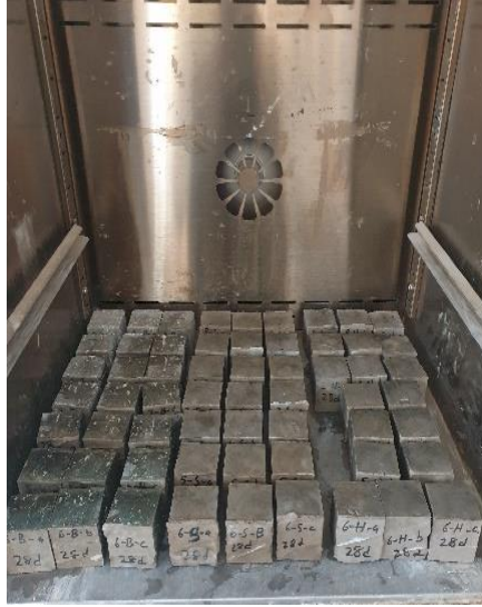
Şekil 3. 21 Geopolimer numunelerin etüv kurusu haline getirilmesi
