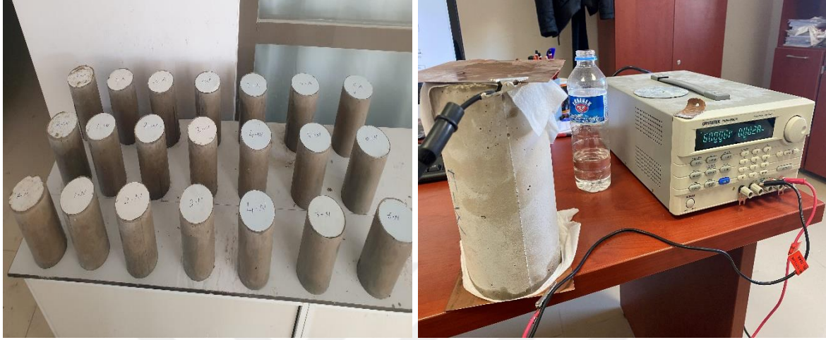
Şekil 3. 23 Elektriksel dirençlerin ölçülmesi için hazırlanan geopolimer harç numuneleri
