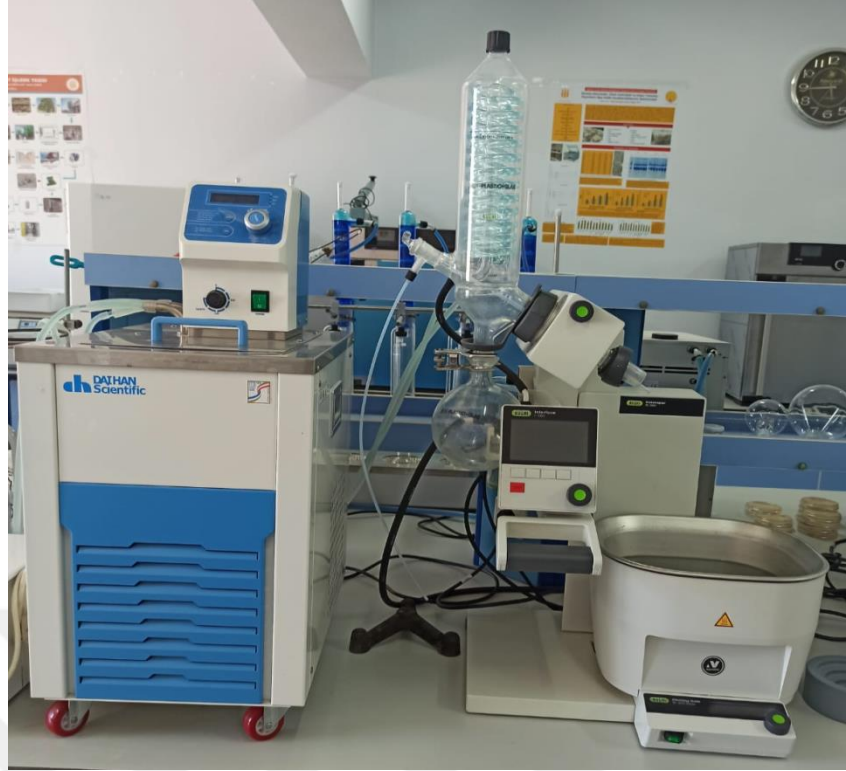
Şekil 3.6: Rotary evaporatör ile yağın ayrıştırılması.
