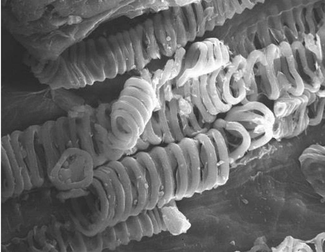
Şekil 4.13: Kavrulmamış kayısı çekirdeği içi zar tozu SEM görüntüleri.
