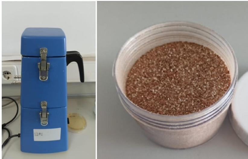
Şekil 3.2: Öğütücü cihaz ve öğütülmüş kaba zar tozu.
