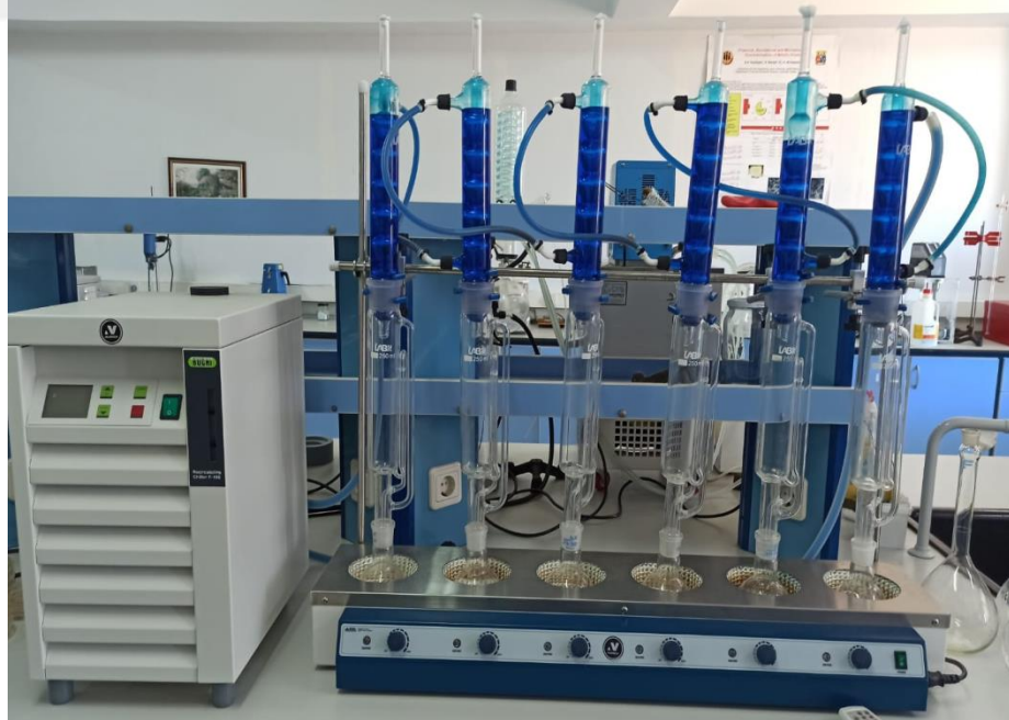
Şekil 3.5: Soxhlet cihazı ile çekirdek içi zar tozundan yağın uzaklaştırılması.
