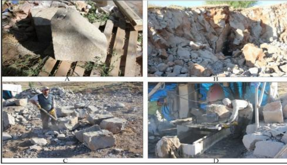
Foto 2A. Bitlis Taşından Bir Örnek. B. Kilise Mahallesinde Yer Alan Taş Ocaklarından Bir Görünüm. C. Taş Ocağında Kesme Taş Üreten Osman Usta'dan Görünüm. D. Bitlis'te El İşçiliği Yanı Sıra Elektrikli Makinelerle de Taş Kesimi Yapılmaktadır.
