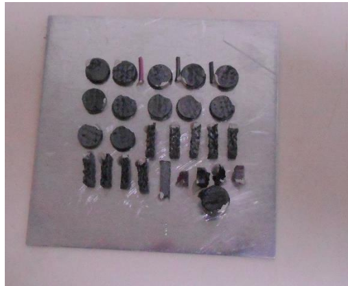
Şekil 3.23: Altın-paladyum kaplanan kompozit numuneler.
