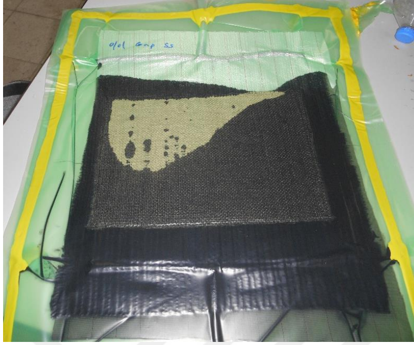
Şekil 3.7: GNP dolgusunda elyaf ıslanmaması sorunu.
