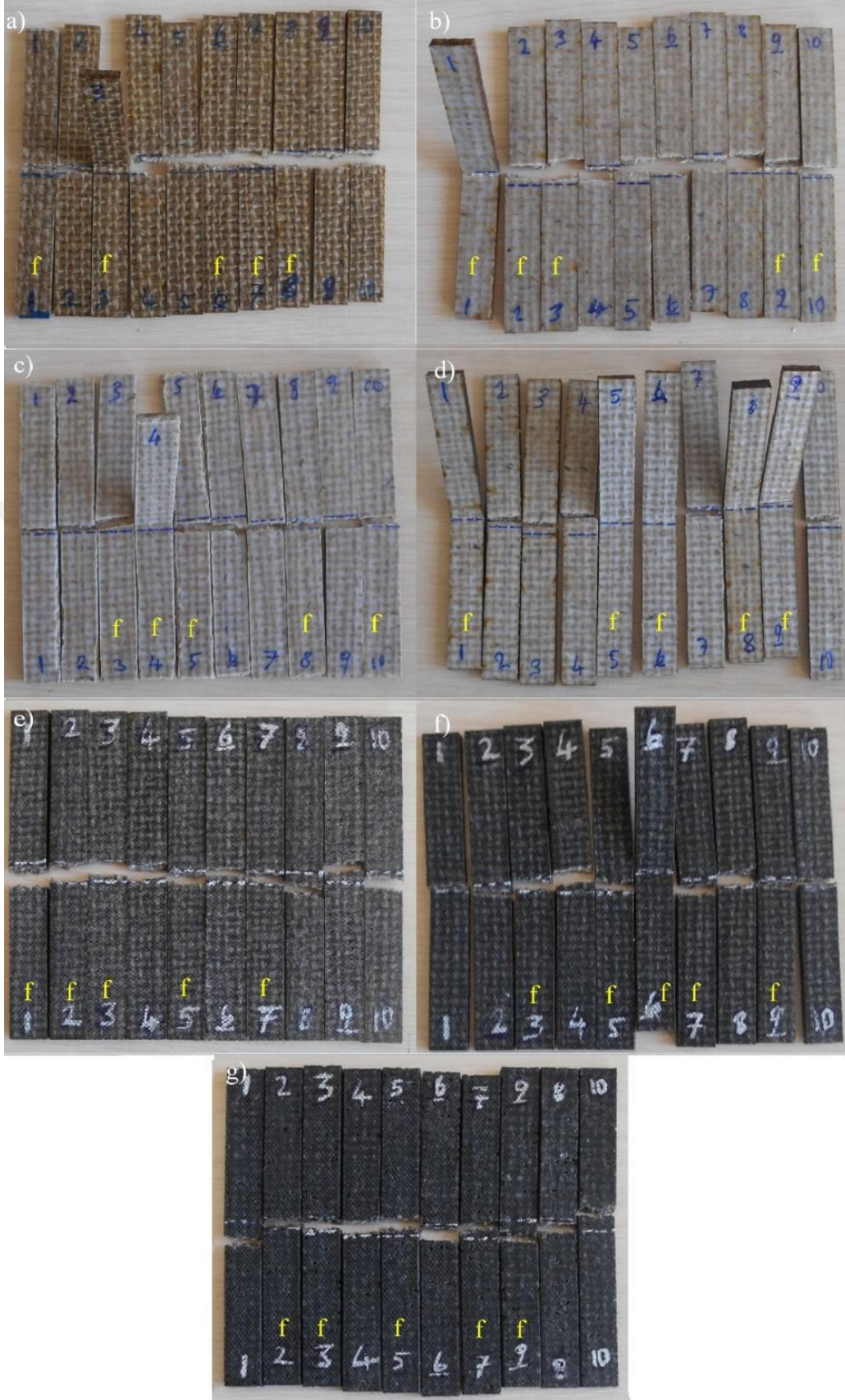
Şekil 4.7: Çentiksiz Charpy darbe testi sonrası hasarlı numuneler, a) Dolgusuz, b) %0.5 TiO 2 dolgulu, c) %1 TiO 2 dolgulu, d) %1.5 TiO 2 dolgulu, e) %0.5 GNP dolgulu, f) %1 GNP dolgulu, g) %1.5 GNP dolgulu numuneler.
