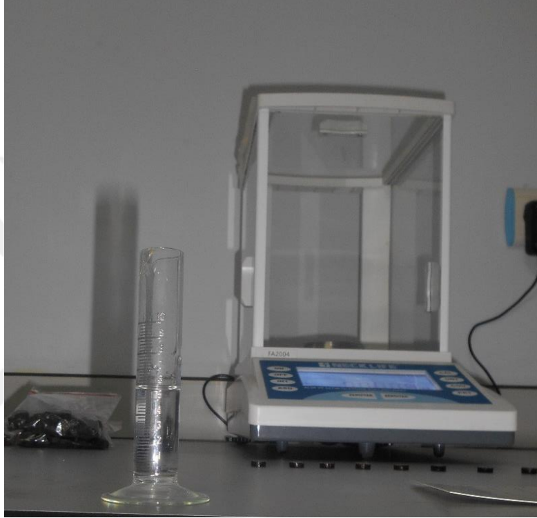
Şekil 3.18: Aşınma numunelerinin yoğunluklarının belirlenmesi.
