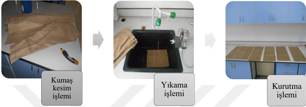
Şekil 3.3: Takviye malzemesinin hazırlanması.
