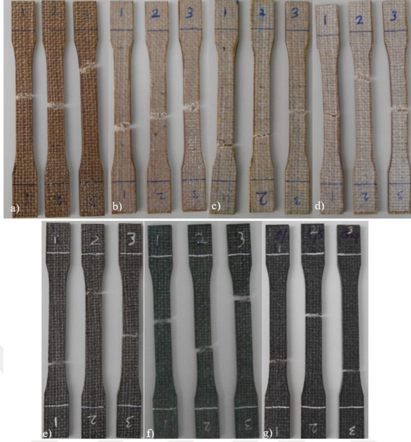
Şekil 4.3: Çekme testleri sonrası kopma hasarları, a) Dolgusuz, b) %0.5 TiO 2 dolgulu, c) %1 TiO 2 dolgulu, d) %1.5 TiO 2 dolgulu, e) %0.5 GNP dolgulu, f) %1 GNP dolgulu, g) %1.5 GNP dolgulu numuneler.
