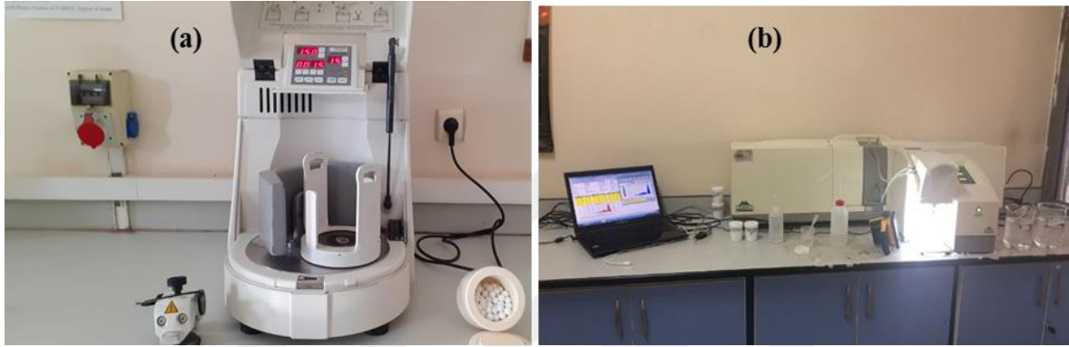
Şekil 3.5: Gezegenel bilyalı değirmen ve öğütücü ortam (a), Mastersizer 2000 tane boyu analiz cihazı (b)
