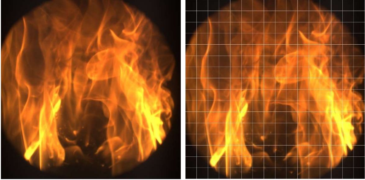
Şekil 4.2 : Alev görüntüsünün gridlere bölünmesi
