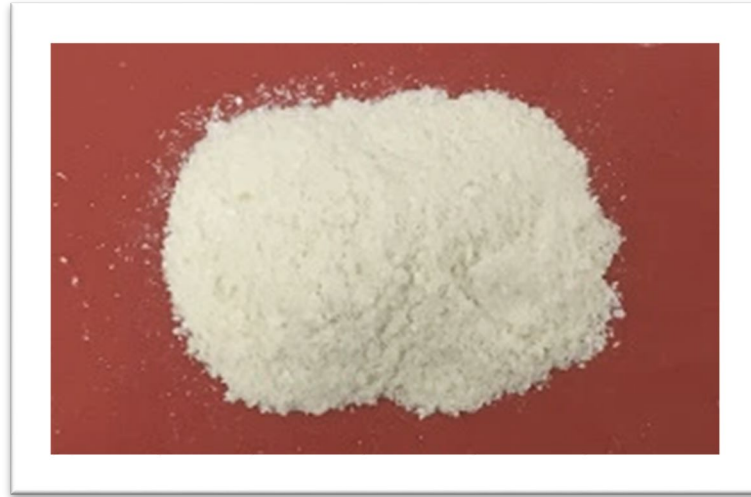
Şekil 2.5: Liyafilizatörde vakumla kurutulmuş Mikrobiyal Kondrotin
