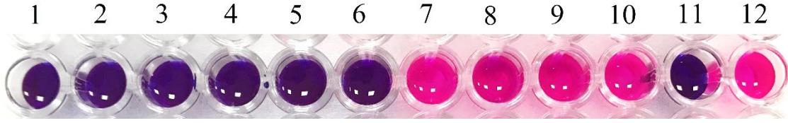
Şekil 3.21: Mikrobiyal KS'nin C. parapsilosis 'e karşı Muller Hinton Broth kullanılarak yapılan Antifungal aktivite testinin mikroplak resmi. Herhangi bir renk değişikliğinin olmadığı 6. kuyucuktaki Mikrobiyal KS konsantrasyonu (%18- 0.18 g/mL) C. parapsilosis için MİK değeri olarak kabul edilmiştir.
