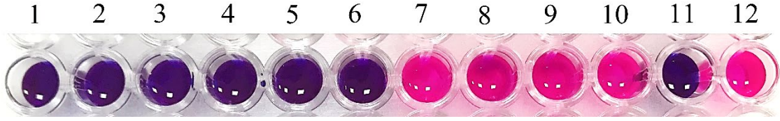
Şekil 3.25: Mikrobiyal KS'nin C. krusei 'ye karşı Muller Hinton Broth kullanılarak yapılan Antifungal aktivite testinin mikropalak resmi. Herhangi bir renk değişikliğinin olmadığı 6. kuyucuktaki Mikrobiyal KS konsantrasyonu (% 18- 0.18 g/mL) C. krusei için MİK değeri olarak kabul edilmiştir.
