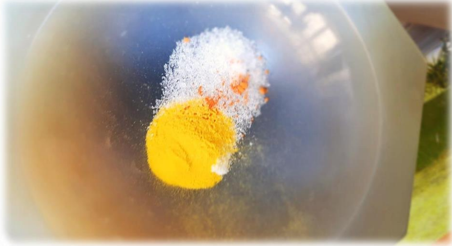
Şekil 2.19. Tüm malzemelerin glikoz ilavesiyle birleşip akik havanda karıştırılması.
