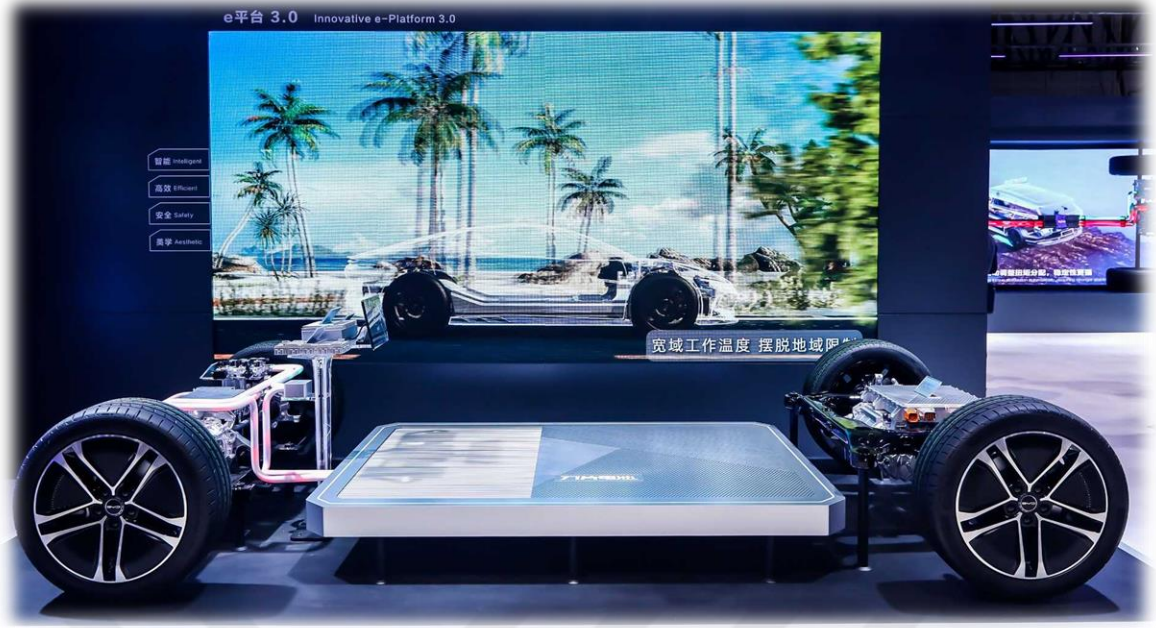
Şekil 1.18. Elektrikli araçlar için BYD e-Platform 3.0 batarya [55].
