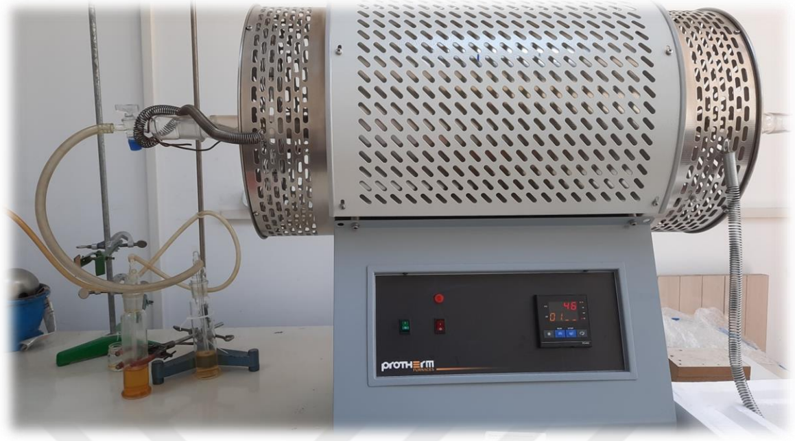
Şekil 2.18. Isıl işlem fırını.
