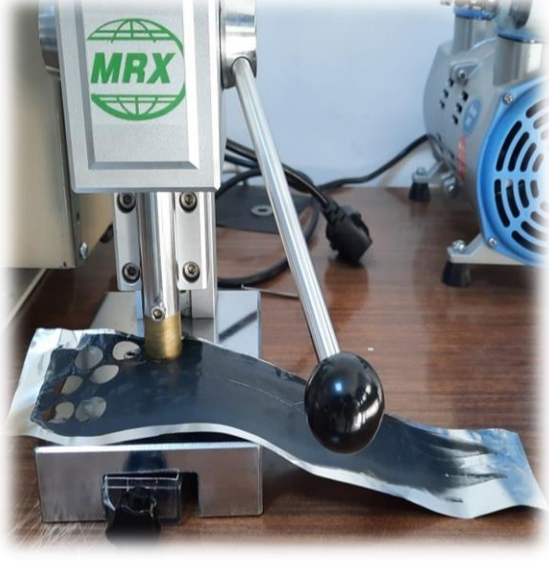
Şekil 2.34. a) Katot presleme, b) Katot kesme işlemleri.
