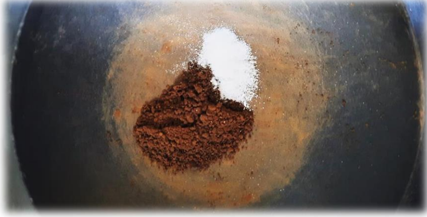
Şekil 2.16. Isıl işlem öncesi karbon kaplama yapmak üzere karışımın hazırlanması.
