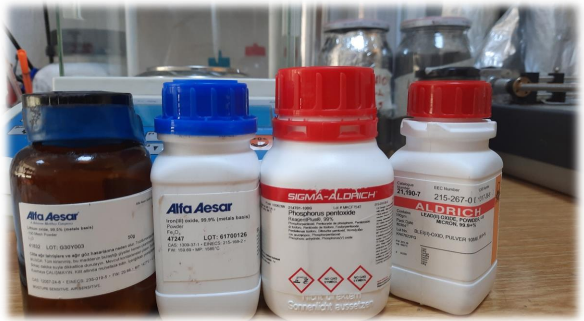
Şekil 2.1. Sentezlenen katotlarda kullanılan \text{Fe}_2\text{O}_3 , \text{Li}_2\text{O} , \text{P}_2\text{O}_5 ve \text{PbO} .
