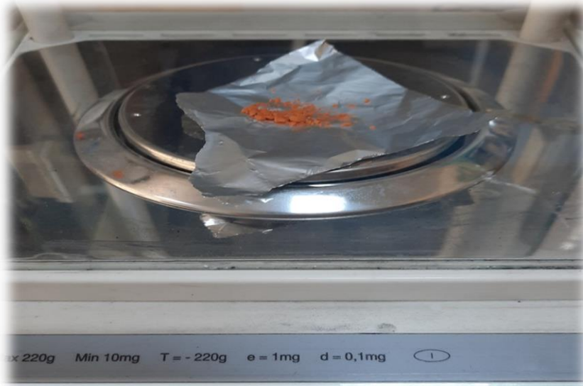
Şekil 2.3. Eklenen Pb (kurşun) elementi tartılırken bir görüntü.
