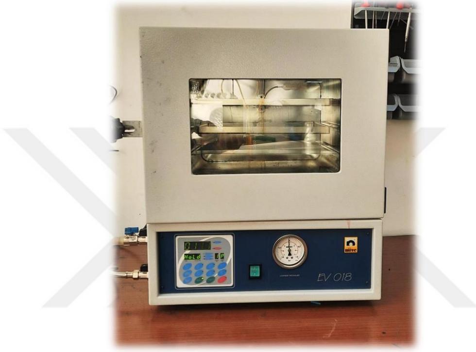
Şekil 2.33. 110° sıcaklıkta katot kurutulmasında kullanılan etüve cihazı.
