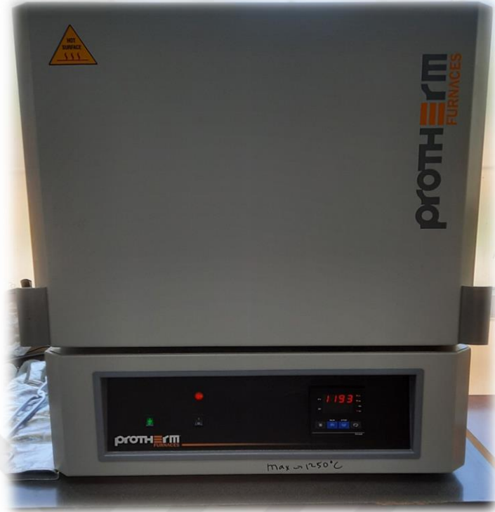
Şekil 2.7. 1200 °C' de ergime işleminin gerçekleştiği fırın.
