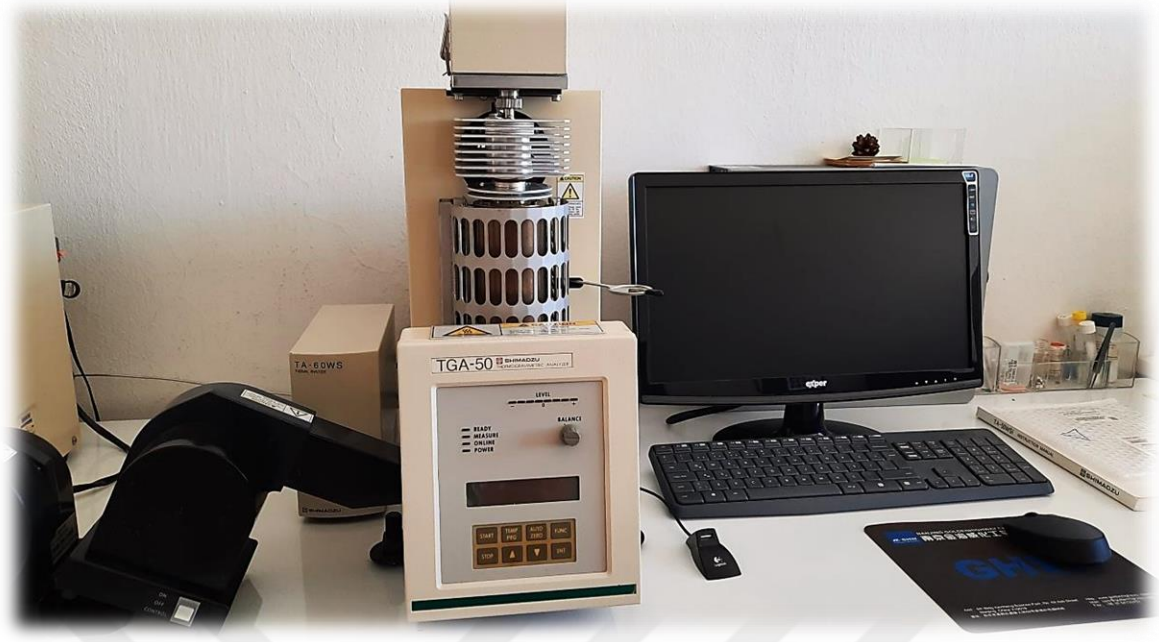
Şekil 2.21. Termogravimetrik analizde kullanılan cihaz.
