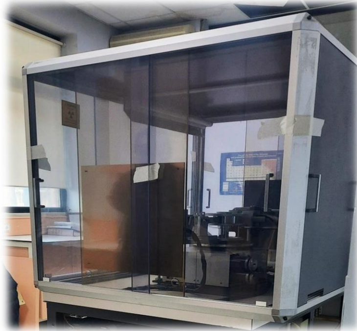
Şekil 2.24. XRD ölçümlerinin yapıldığı üniversitemize ait ölçüm cihazı.
