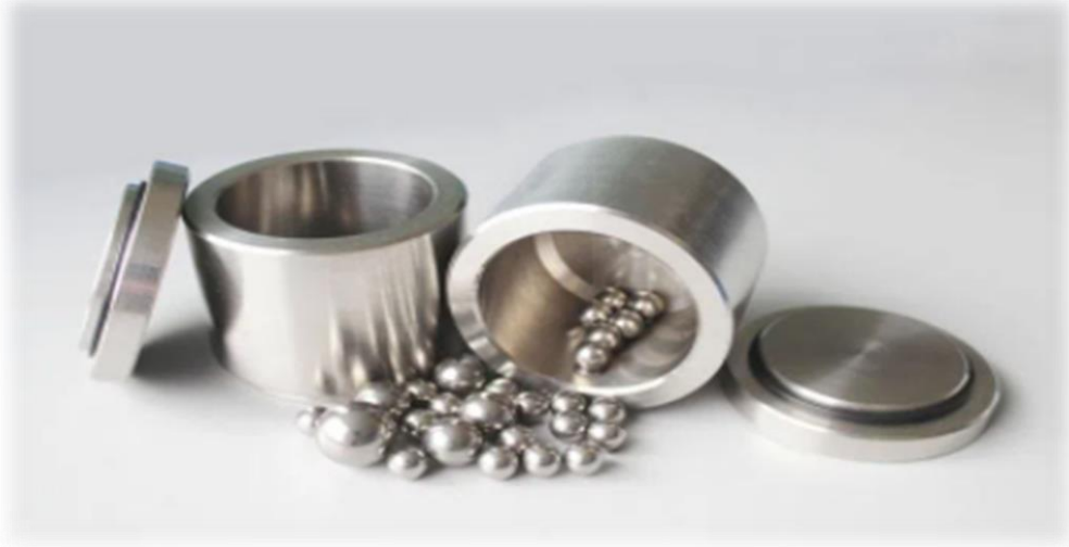
Şekil 2.4. Çelik bilyalı değirmen ve bilyeleri [64].
