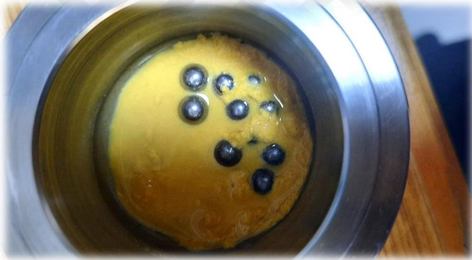
Şekil 2.20. Tüm malzemenin ilk değirmene katılması.
