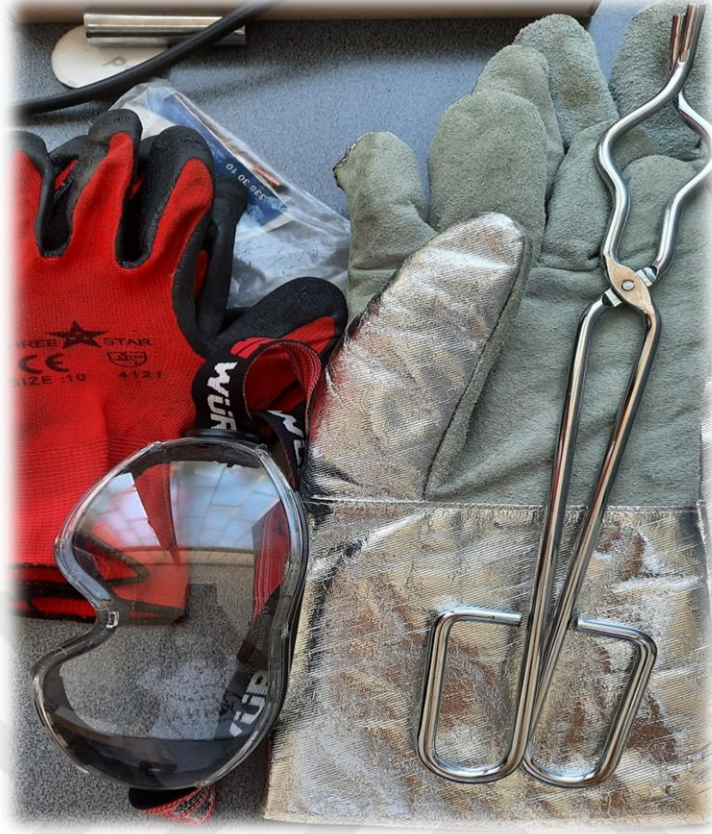
Şekil 2.8. Yüksek sıcaklıktan zarar görmemek için kullanılan yanmaz eldivenler, maşa ve ısıdan etkilenmeyen gözlükler.
