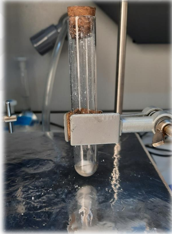
Şekil 2.30. PVDF' nin NMP' de çözülmesi için karışıma koyulması.
