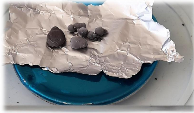
Şekil 2.12. Sıvı azottan çıkarılıp elde edilen cam malzemenin görüntüsü.
