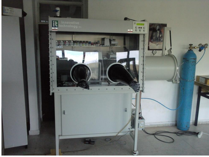
Şekil 3.19. Glove box sistemi.
