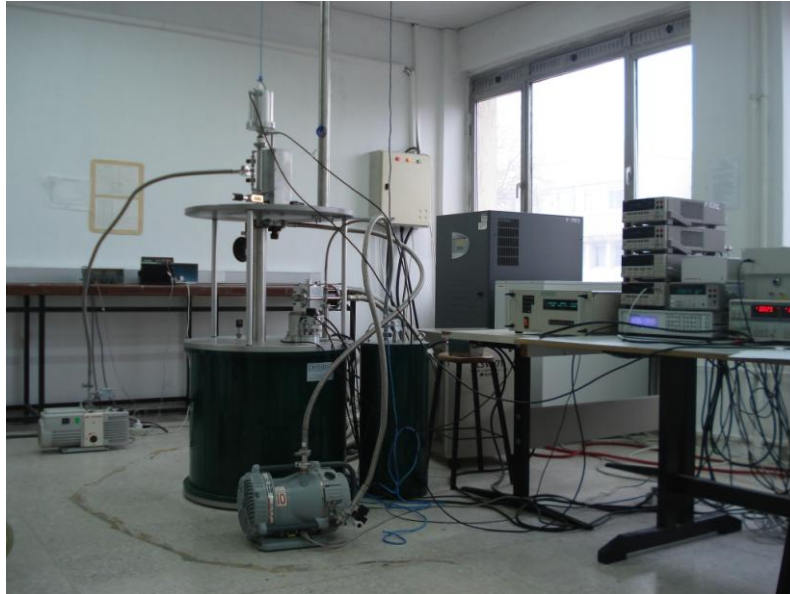
Şekil 3.27. Vibrating Sample Magnetometer (VSM) sisteminin şematik gösterimi [27].
