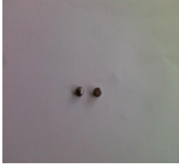
Şekil 4.27. Arc-melting işlemiyle üretilen numunelerin resimleri.
