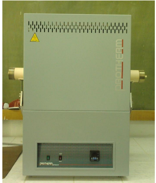
Şekil 3.22. Havası boşaltılmış kuvars cam tüp içindeki numune. Şekil 3.23. Isıl işlem fırını.
