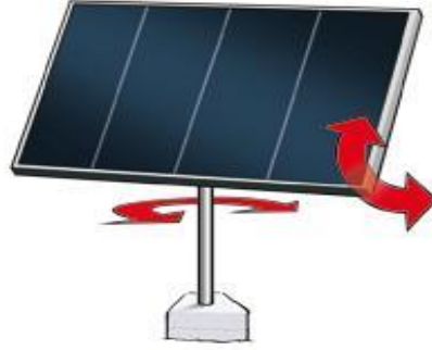
Şekil 2.21. Panellerin çift eksende hareket edebilir şekilde yerleştirilmesi [31]
