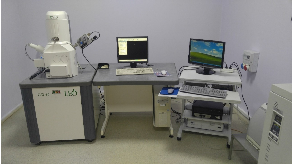
Şekil 3.3. SEM/EDX analiz cihazı
