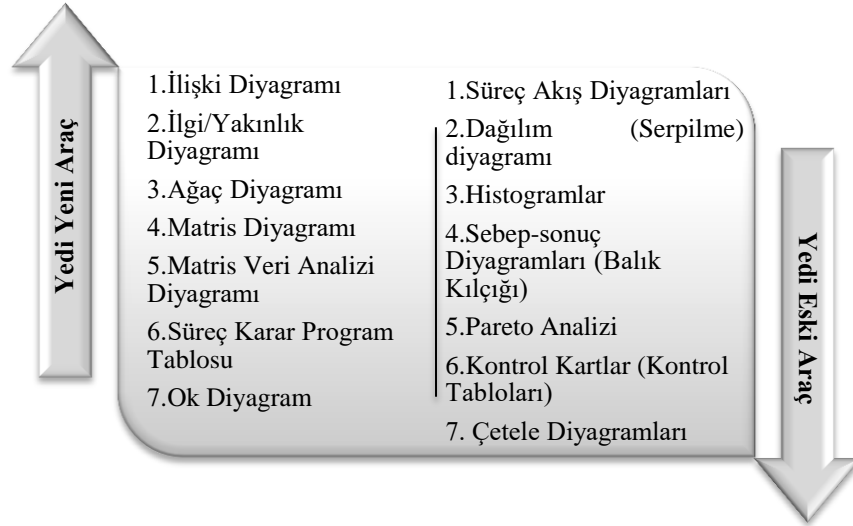
Şekil 2.5: İstatistiksel Süreç Kontrolünde Kullanılan Problem Çözme Teknikleri (Işık, 2006: 551-552)
