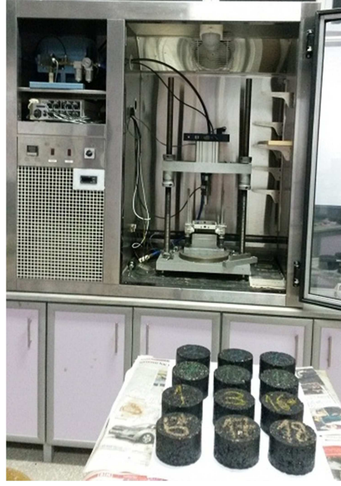
Şekil 4.44 UMATTA deney aleti ve sünme deneyi uygulanan numuneler
