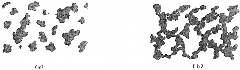
Şekil-4.2. a) Polimer kesikli sistemlerde yapının şematik görünümü. b) Cam parçacık boyutunun metal parçacıklardan büyük olduğu durumda toz karışımlardaki yapının şematik görünümü.
