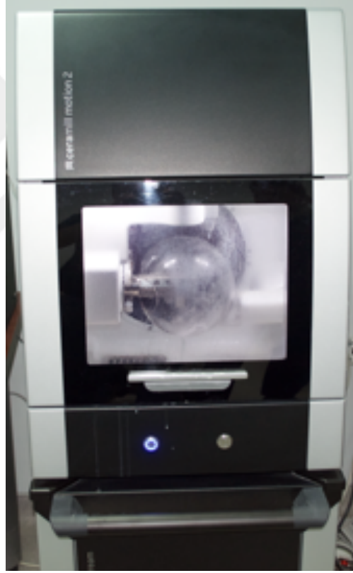
Şekil 3.9. PYMF grubuna ait metal altyapıların üretilmesinde kullanılan frezeleme cihazı
