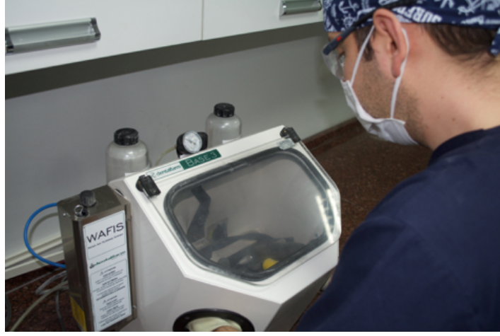
Şekil 3.17. Çalışmada kullanılan kumlama cihazı
