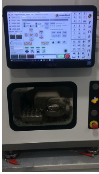
Şekil 3.12. PSMF ve TF grubuna ait örneklerin üretilmesinde kullanılan frezeleme cihazı
