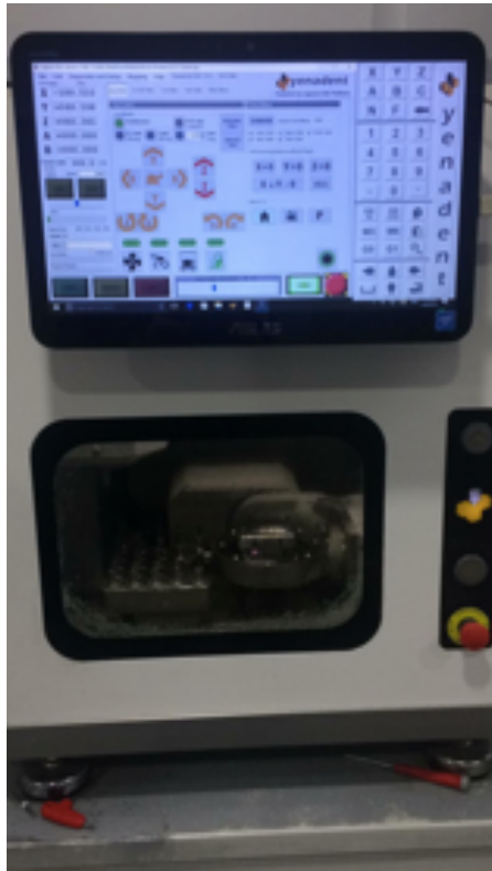
Şekil 3.3. Mum blokların kazınmasında kullanılan frezeleme cihazı
