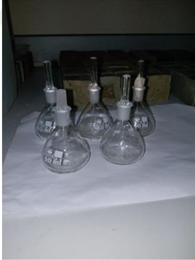
Şekil 3.8: Özgöl ađırlık tayininde kullanılan píknometreler
