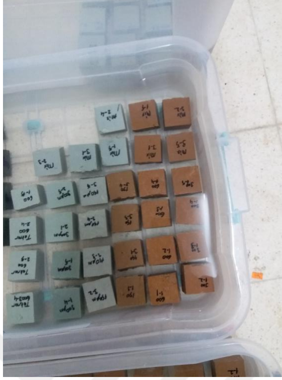
Şekil 3.12: Tuz kristallenmesi deneyine tabii tutulan yapay mermer örneklerine ait görüntü.
