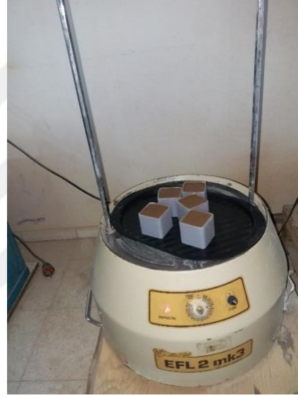
Şekil 3.6: Yapay mermerlerin hazırlanma ve titreşime tabi tutulma aşaması
