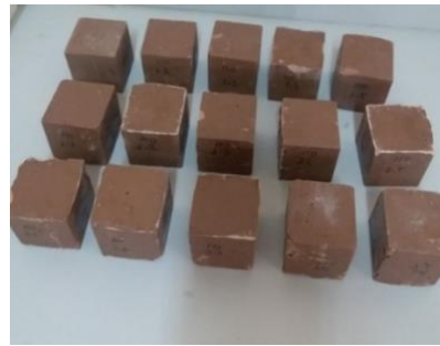
Şekil 3.7: Cam atıktan üretilen yapay mermer örnekleri (a), seramik atıktan üretilen yapay mermer örneklerine (b) ait görüntü.
