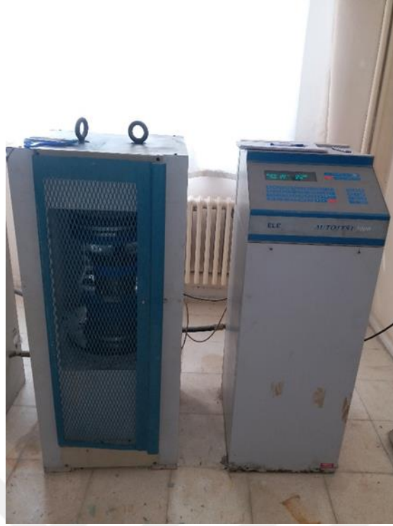
Şekil 3.9: Tek eksenli basınç dayanımı ölçümü.
