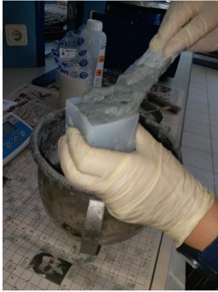
Şekil 3.6: Yapay mermerlerin hazırlanma ve titreşime tabi tutulma aşaması
