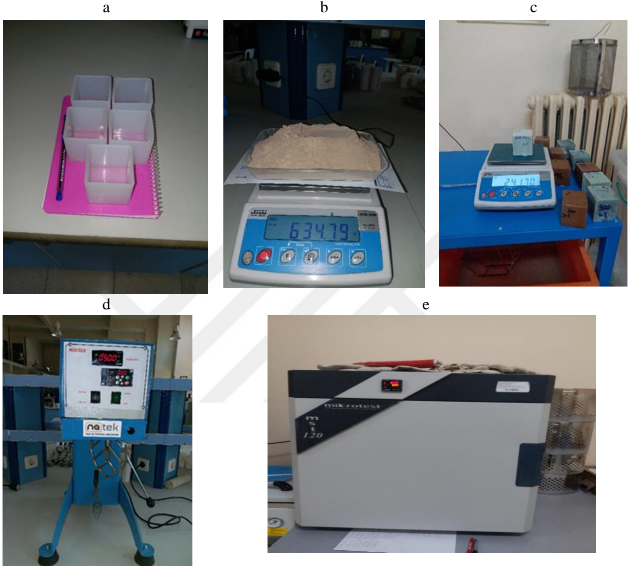
Şekil 3.3: Yapay mermer üretiminde kullanılan silikon kalıp (a), hassas terazi (b), Arşimet sehпасı (c), mikser (d), etüve (e) ait görüntüler.
