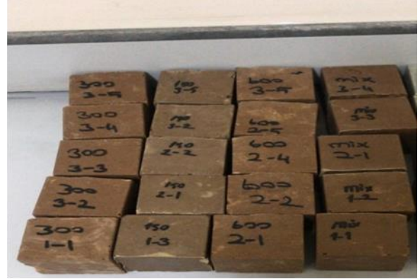
Şekil 4.14: Termal şok döngüleri sonrası cam atık katkılı örneklere (a) ve seramik atık katkılı örneklere (b) ait renk değişimi görüntüsü.
