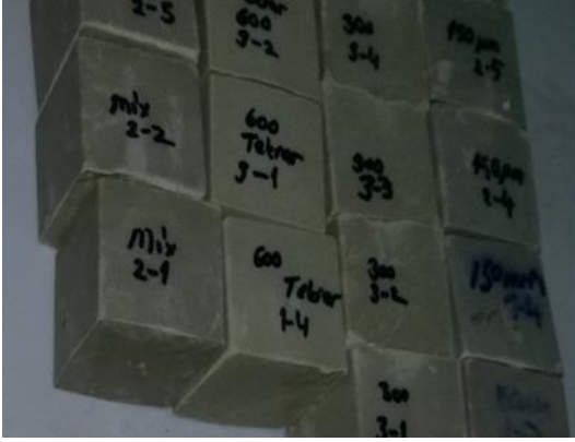
Şekil 4.14: Termal şok döngüleri sonrası cam atık katkılı örneklere (a) ve seramik atık katkılı örneklere (b) ait renk değişimi görüntüsü.
