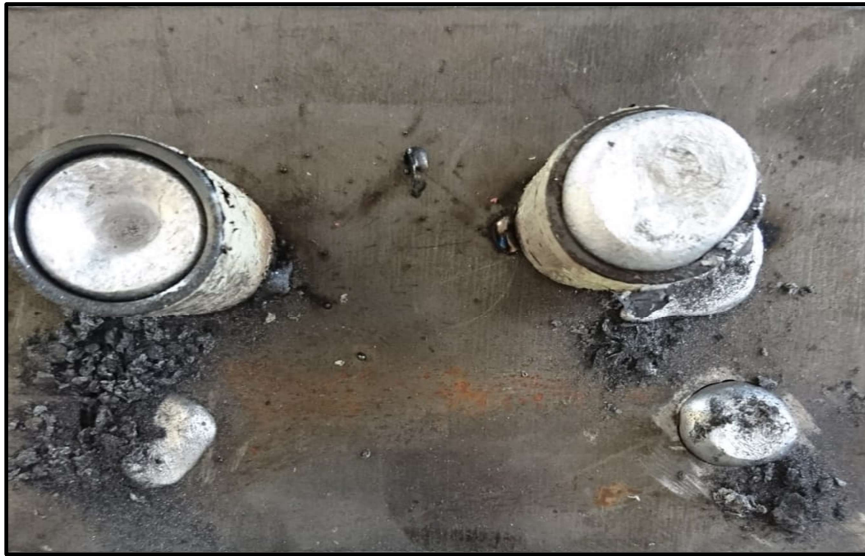
Őekil 4.7. AMMK'lerin metal kalıplara dkm iŐlemi.
