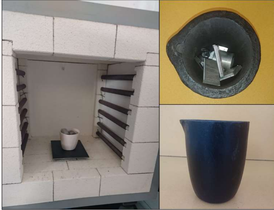
Şekil 4.5. Alüminyum alaşımlarının grafit ve seramik potalarda eritilmesi.
