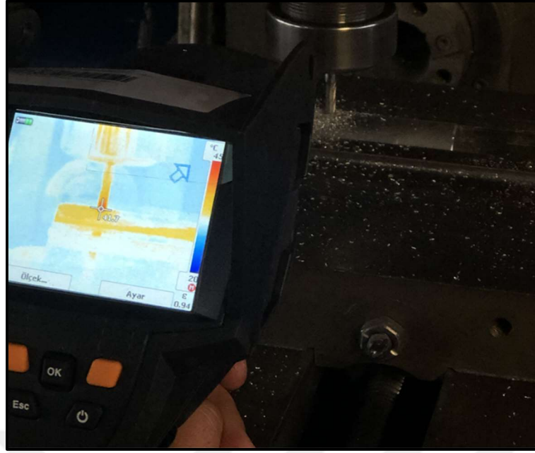
Şekil 4.13. Frezeleme işlemesi sırasında sıcaklık değerinin termal kamera ile ölçülmesi.
