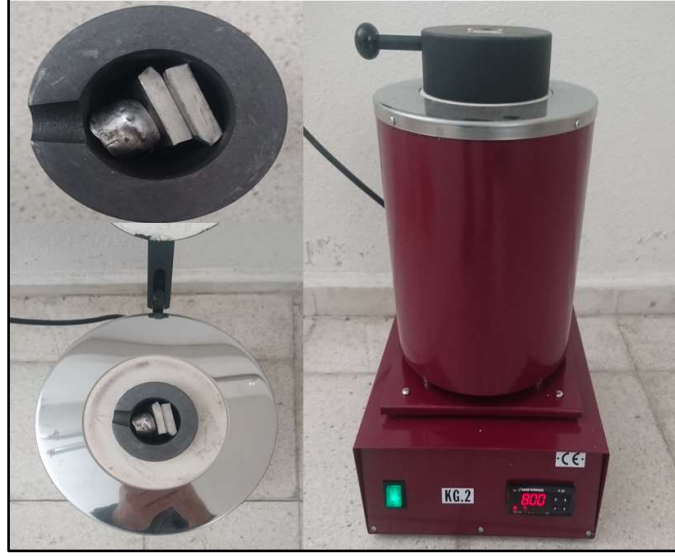
Şekil 4.4. Elektrikli eritme ocağı kullanılarak alüminyum alaşımlarının eritilmesi işlemi.
