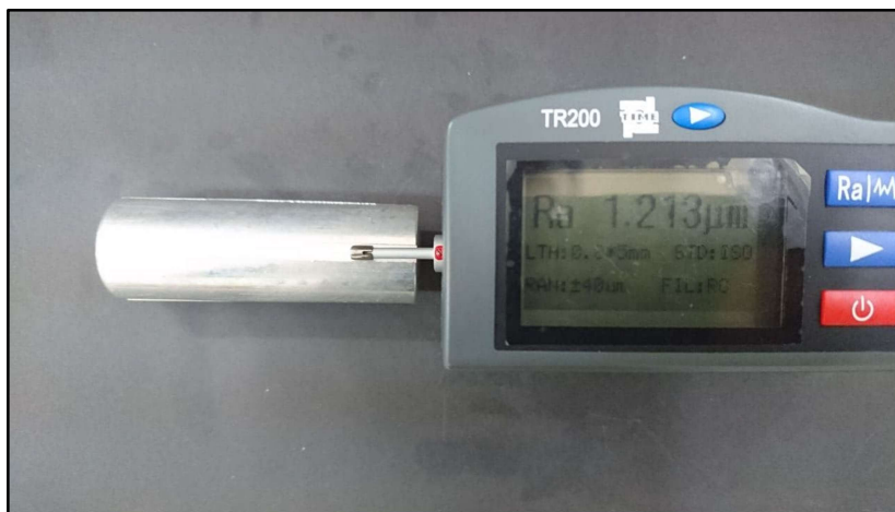
Şekil 4.15. İşlenmiş parçaların yüzey pürüzlülüğünün ölçülmesi.
