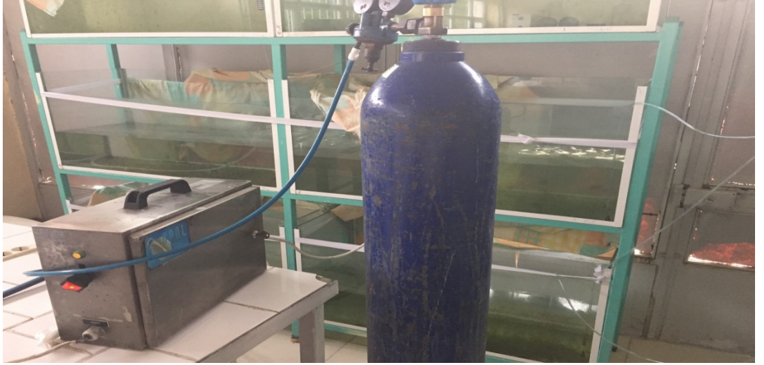
Şekil 3.3. Pestisit kalıntılarını ozon jeneratorü ile giderme
