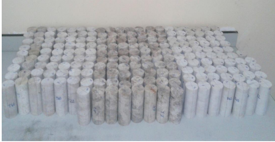
Şekil 4.6. Tek eksenli basma dayanımında kullanılan numuneler
