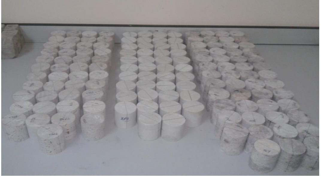
Şekil 4.8. Nokta yükleme deneyi için kullanılan numuneler
