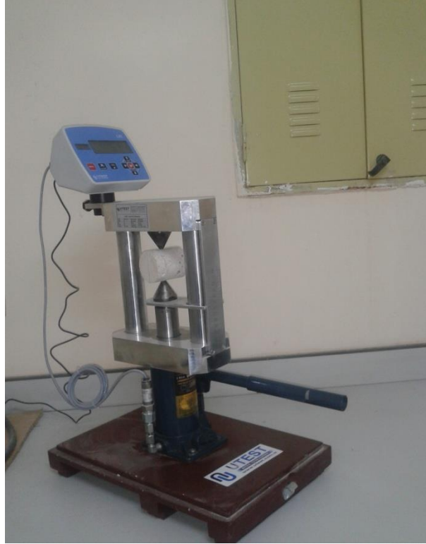
Şekil 4.7. Nokta yükleme test cihazı
