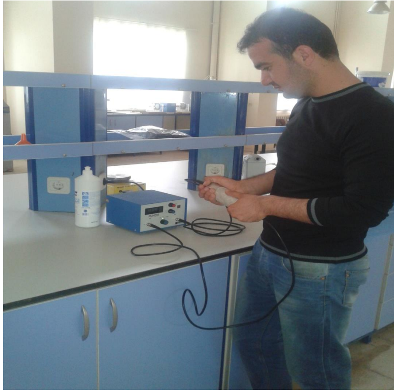
Şekil 4.9. Sonik hız deneyi cihazı
