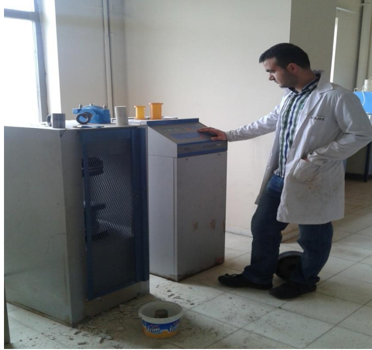
Şekil 4.5. Tek eksenli basma dayanımında kullanılan pres
