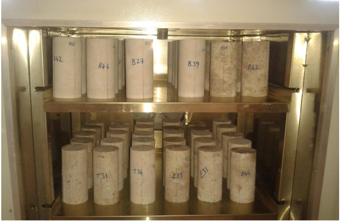
Şekil 4.2. Kayaçların fiziksel özelliklerini belirlemede kullanılan numuneler
