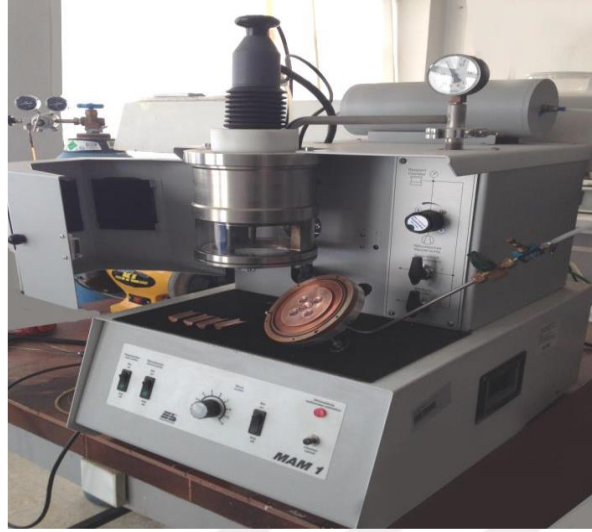
Şekil 4. 2 : Eritme işleminin yapıldığı ark eritme sistemi
