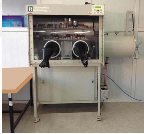
Şekil 4. 1 : Argon ortamında kütlelerin tartıldığı glove box sistemi
